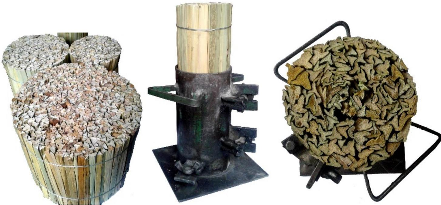
**FOTOGRAFÍA 14: PROBETAS PARA ENSAYOS A COMPRESIÓN. FUENTE: PROPIA.**
