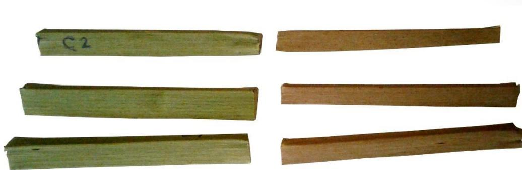
FOTOGRAFÍA 18: FIBRAS DE ENSAYOS DE HUMEDAD. FUENTE: PROPIA.
