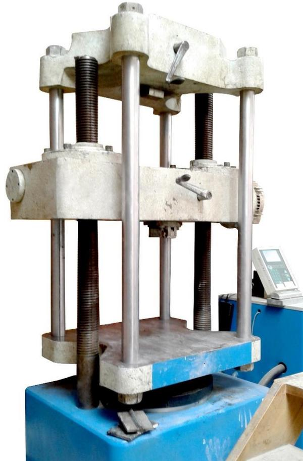
FOTOGRAFÍA 9: MÁQUINA DE ENSAYOS A TRACCIÓN. FUENTE: PROPIA.
