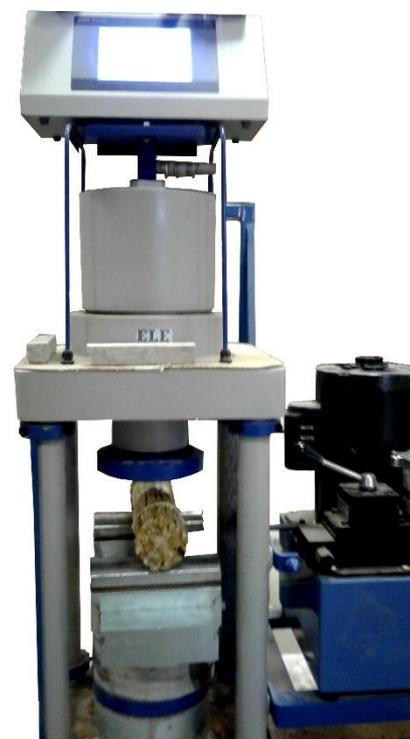
Calibrando los equipos a los niveles más bajos permisibles (adobe) debido a la falta de normas técnicas para este tipo de ensayos.
