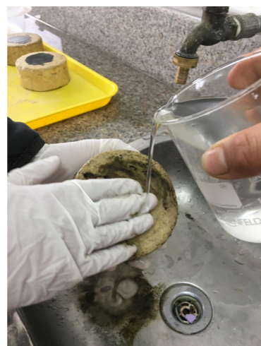
REMOCIÓN DE MANCHA AGUA CALIENTE
