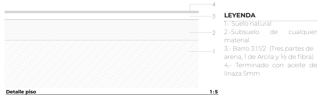
Figura 8.- Detalle de Piso de Reay & Thomson Elaboración: Autor.
