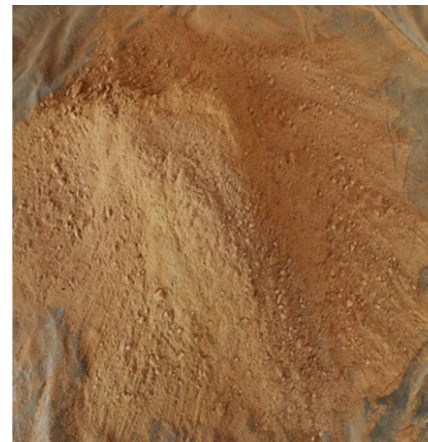
TIERRA TAMIZADA EN MALLA DE 3/8
