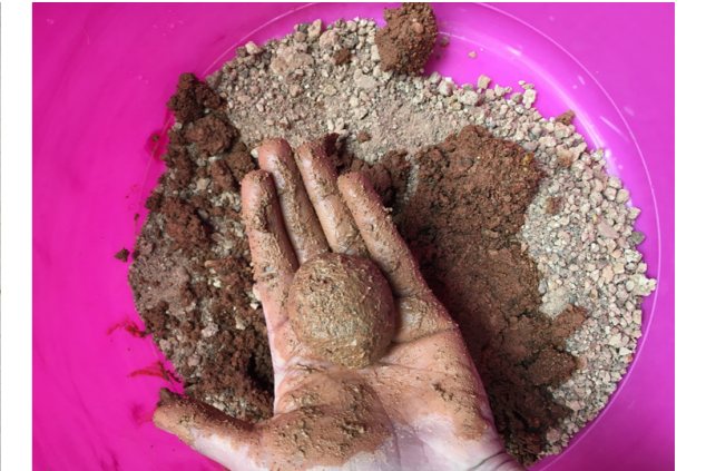
ENSAYO DE LA BOLA
