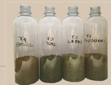
Imagen 14.- Ensayo de sedimentación Fuente: Autor. Elaboración: Autor.
