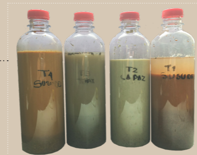
Imagen 15.- Muestras de tierra revueltas en agua Fuente: Autor. Elaboración: Autor.
