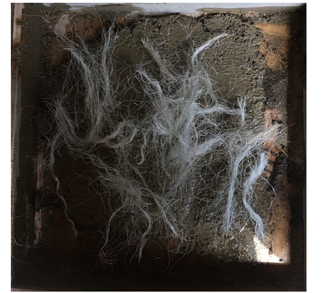
ADICIÓN DE CABUYA A LA MEZCLA
