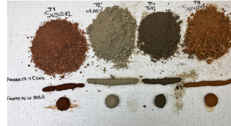
ENSAYO DE LA PRESENCIA DE ARCILLA Y HUMETACION
