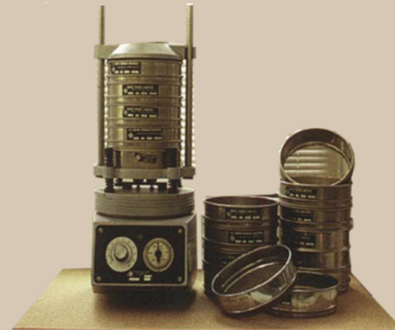
Imagen 21.- Ensayo de granulometría: Tamizadora y juego de tamices Fuente: Autor. Elaboración: Autor.
