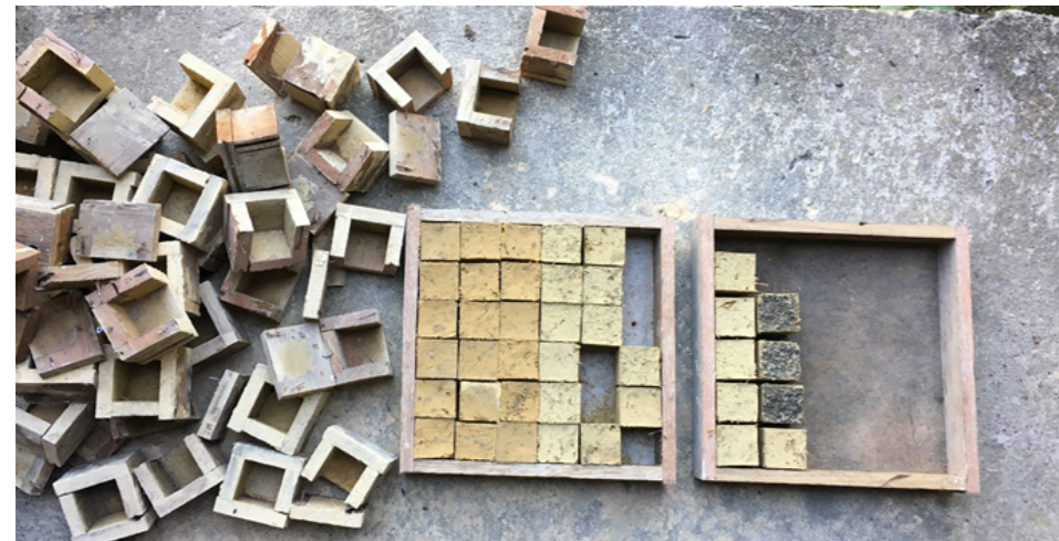
DESENCOFRADO DE LAS MUESTRAS
