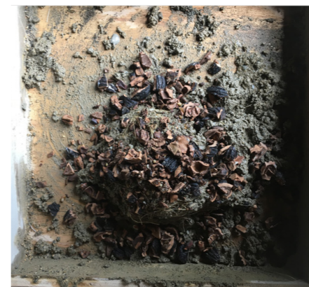
ADICIÓN DE CASCARILLA DE TOCTE
