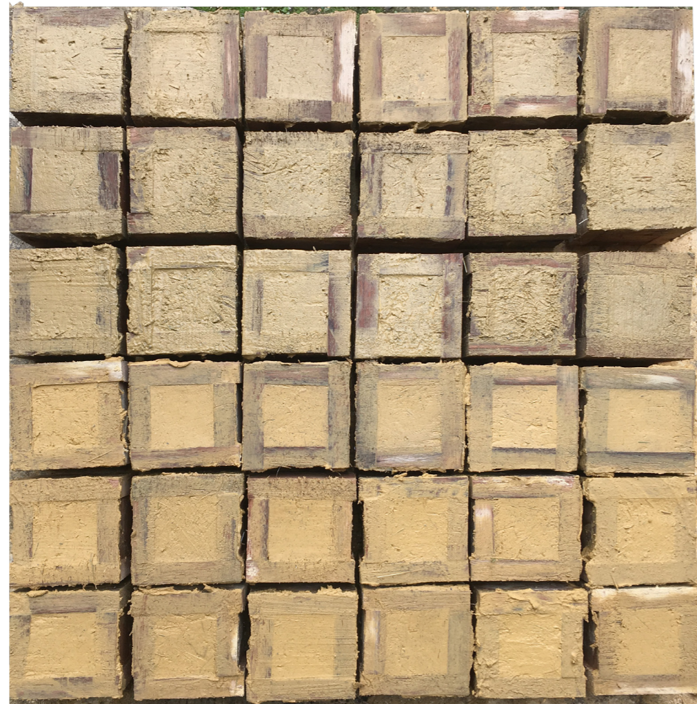
Imagen 28.- Muestras de dosificación M8 para ensayos de resistencia a los agentes químicos. Fuente: Autor. Elaboración: Autor.
