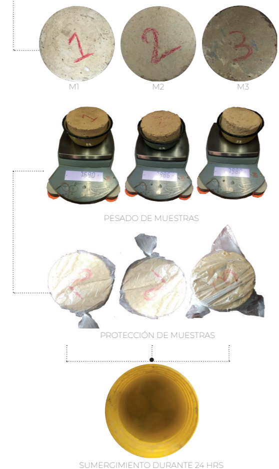
Diagrama 8.- Ensayo de absorción de agua. Fuente: Autor. Elaboración: Autor.
