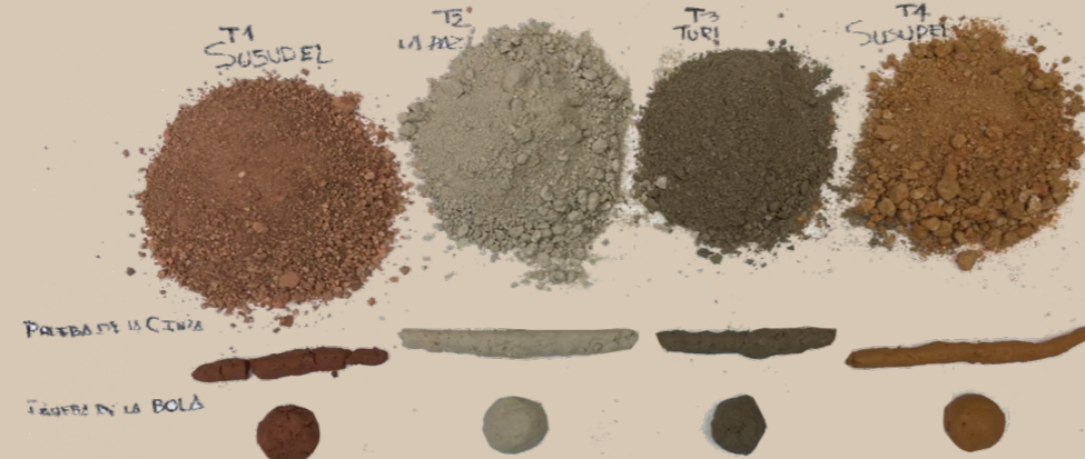
Imagen 18.- Ensayo de la cinta de barro o presencia de arcilla. Fuente: Autor. Elaboración: Autor.
