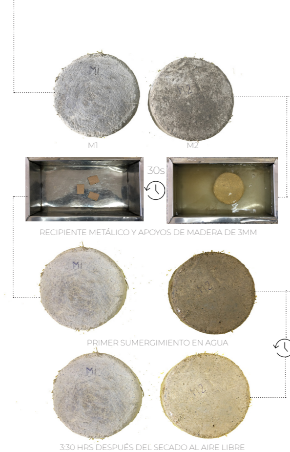
Diagrama 9.- Ensayo de humectación. Fuente: Autor. Elaboración: Autor.
