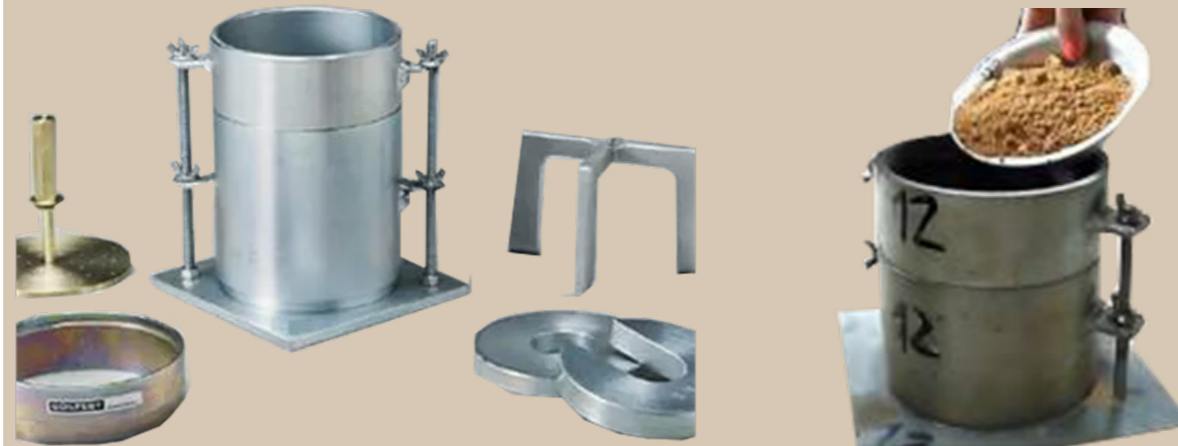
Imagen 23- Ensayo de compactación de suelos con Proctor. Fuente: Autor. Elaboración: Autor.
