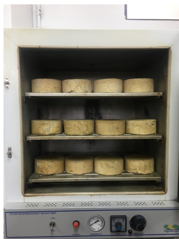
SECADO EN ESTUFA A 110°C
