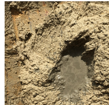
ADICIÓN DEL 10% CEMENTO
