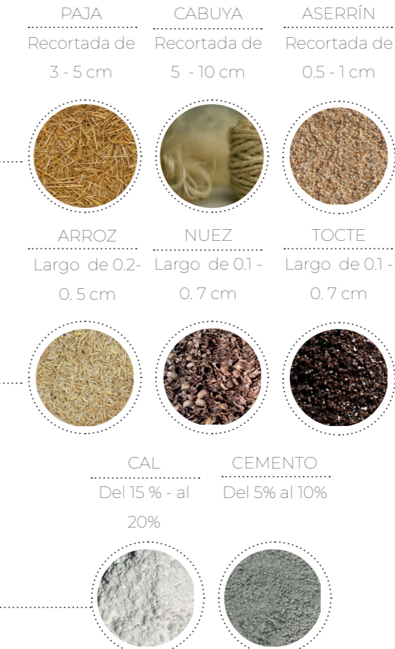
Diagrama 3.- Fibras y cascarilla naturales, estabilizantes. Fuente: Autor. Elaboración: Autor.
