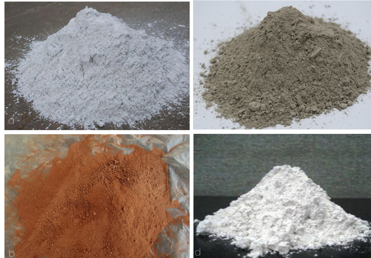
Imagen 8.- estabilizantes para construcción en tierra según la norma ASTM E2392/E2392M Edición: Carlos Miguel Tapia Vera Fuente: https://arquigrafico.com/cemento-cal-y-yeso-materiales-de-agarre-por-excelencia/
