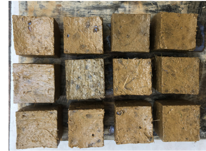
MUESTRAS CON IMPERMEABILIZANTES
