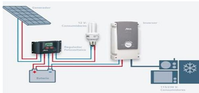
Figura 5. Sistema Fotovoltaico Aislado.
