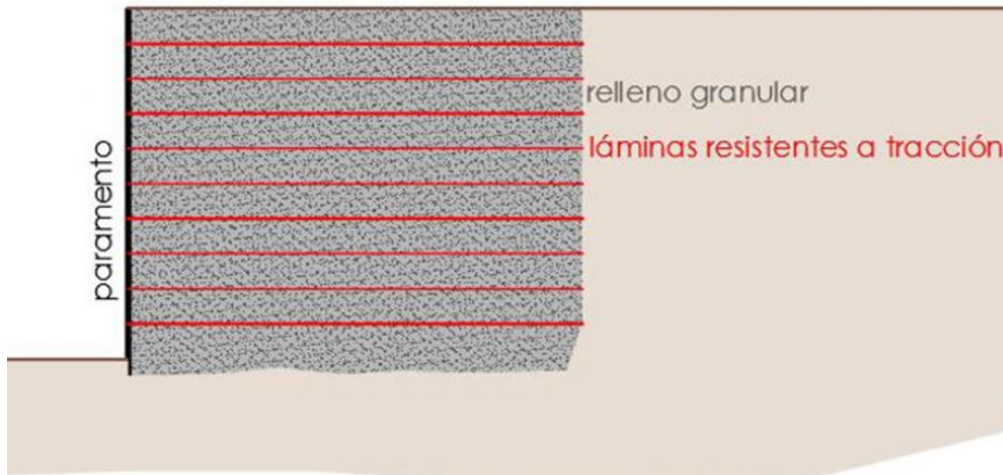
Figura 31: Muro de tierra armada
