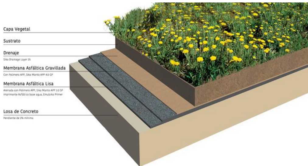
Figura 47: Detalle de cubierta verde
