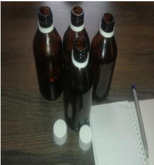
**Figura 9:** Frasco para la recolección de las muestras de agua
