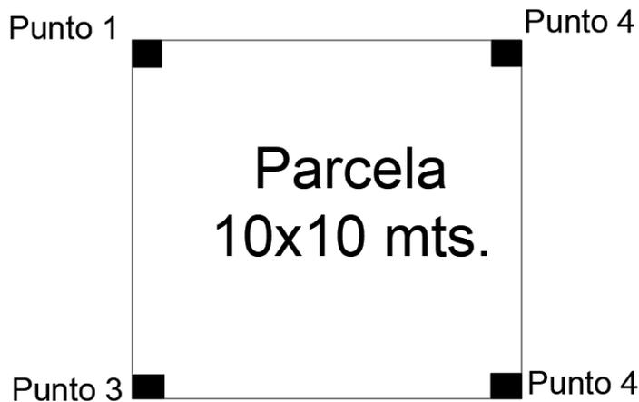
**Figura 6:** Ubicación de los pluviómetros en las parcelas seleccionadas.
