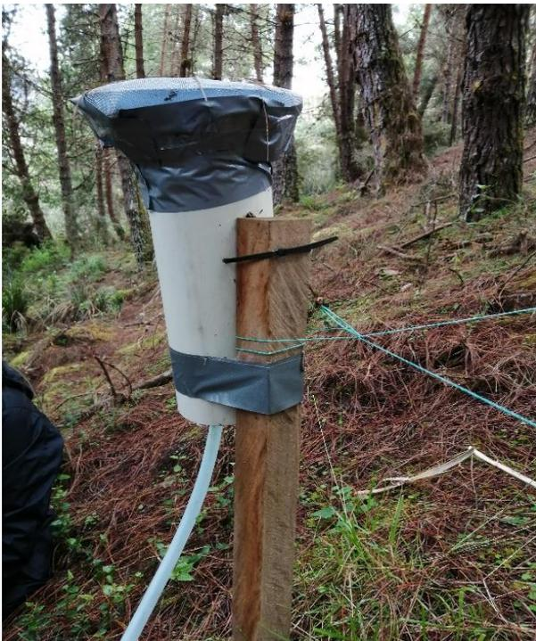
**Figura 7:** Equipo de captación de agua de lluvia.
