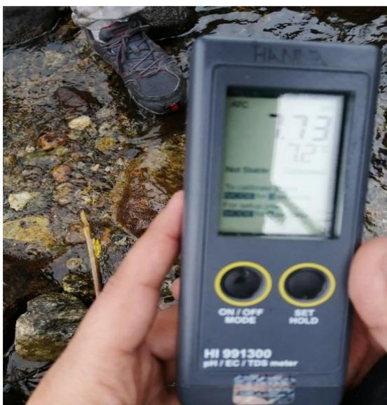
**Figura 5:** Multiparamétrico utilizado para la investigación.
