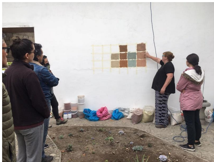
Figura 20 Pruebas de adherencia y colores del caso de estudio
