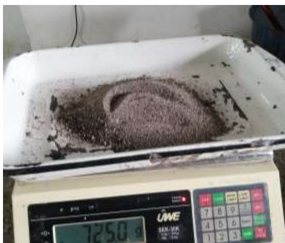
Ensayo granulométrico de la arena
