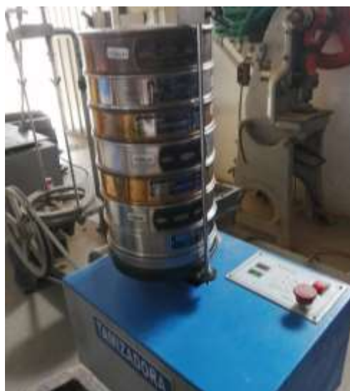
Ensayo granulométrico de la arena
