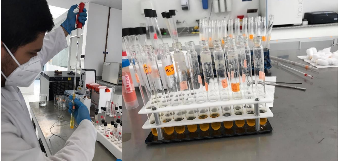
Figura 12: Oxidación de materia orgánica sobrante con dicromato de potasio
