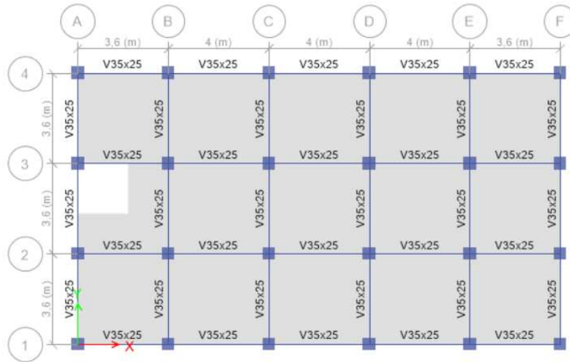
Ilustración 27. Representación estructural Piso 1 a 5 – 6P - SMF
