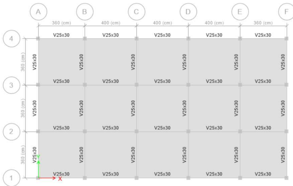
Ilustración 24. Representación estructural Piso 3 – 3P - SMF
