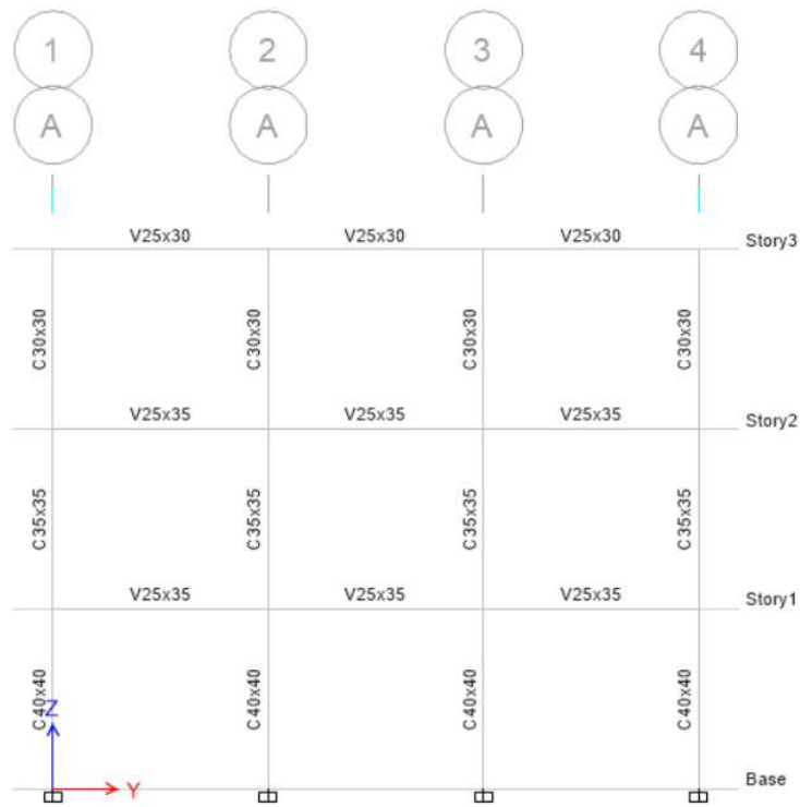
Ilustración 25. Vista frontal del sistema estructural 3P - SMF
