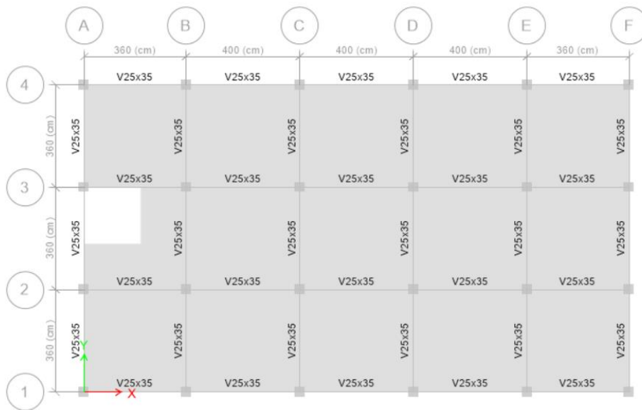
Ilustración 23. Representación estructural Piso 1 a 2 – 3P - SMF
