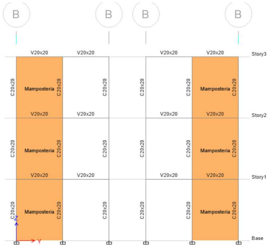
Ilustración 13. Vista lateral del sistema estructural Eje B, C, E, F - MC Fuente: Etabs
