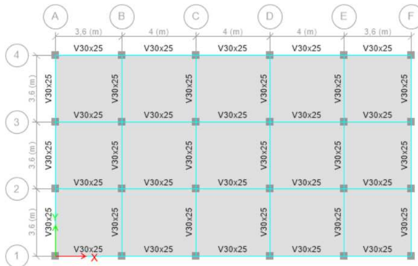
Ilustración 28. Representación estructural Piso 6 – 6P -SMF
