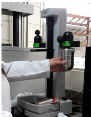
Figura 30: Estación de carga y despresurización de oxígeno
