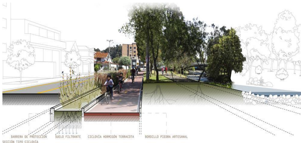
Figura 12: Sección vial con implementación de barrera vegetal, suelo filtrante, ciclovía terracota y bordillo artesanal.
