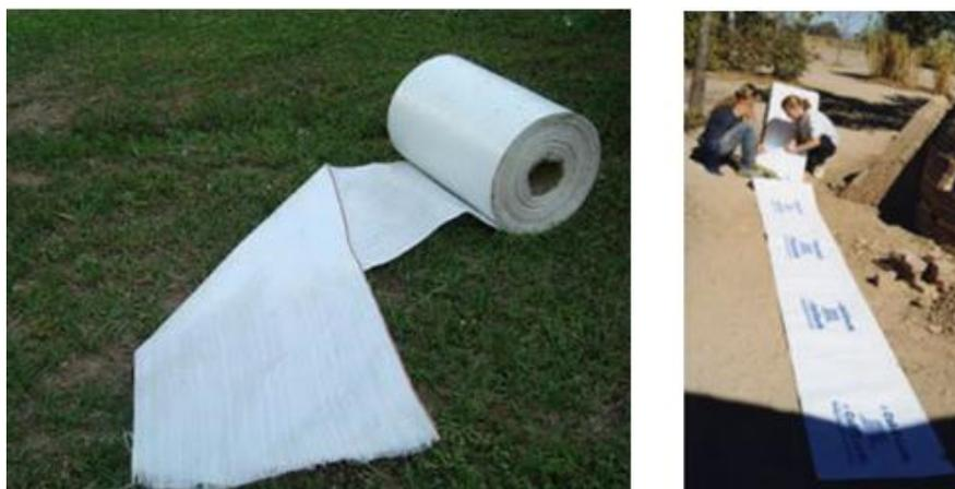
**Imagen 43:** Rollo de saco de polipropileno
