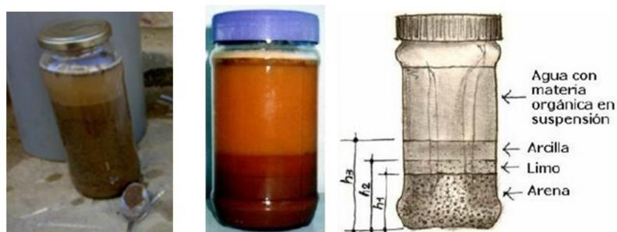
**Imagen 42:** Separación por decantación y cálculo de la composición granulométrica: **Arena**(%)=( $h_1/h_3$ )x100; **Limo** (%)=( $h_2-h_1/h_3$ )x100; **Arcilla**(%)=( $h_3-h_2/h_3$ )x100.
