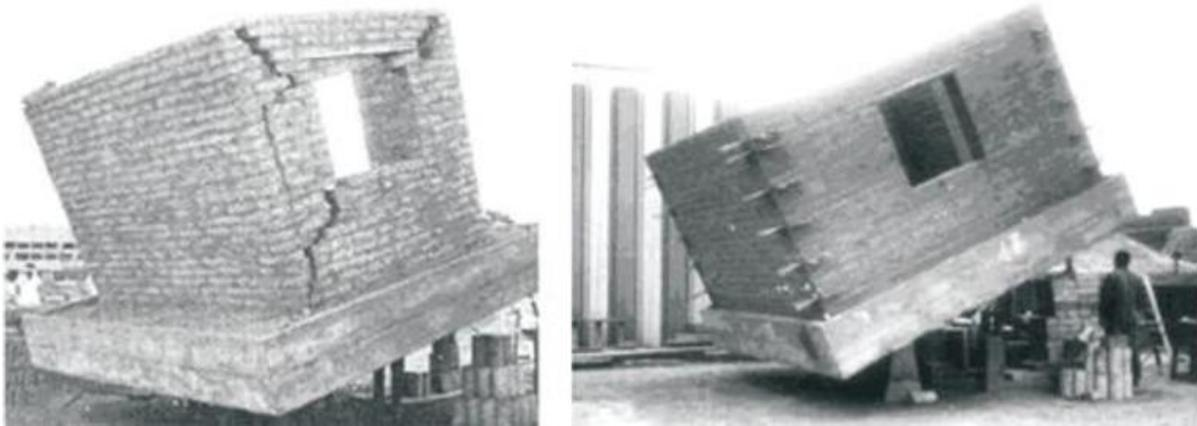
**Imagen 7:** Ensayo plataforma inclinable, PUCP, 1973-1978
