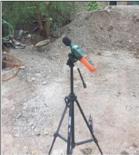
Figura 18: Medición de Nivel de Ruido (entrada/salida de volquetas).
