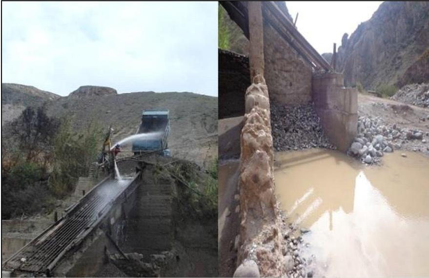
Figura 7: Criba de lavado y clasificación del material extraído.
