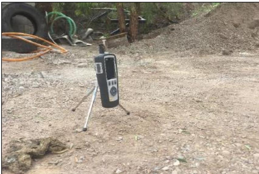
Figura 20: Medición de calidad del aire (entrada/salida de volquetas).
