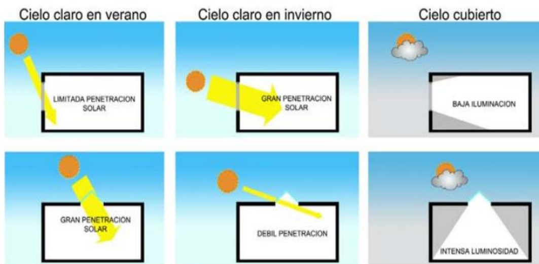
Imagen N°52 Penetración de la luz lateral y cenital en invierno y verano.
