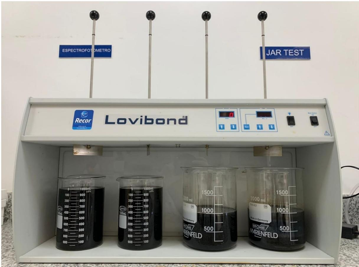
*Anexo 4 Muestras de lixiviado con adición de Sulfato de Aluminio*
