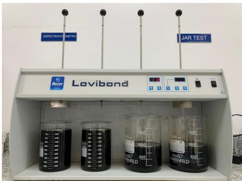
Figura 4 Test de jarras con Sulfato de Aluminio en los vasos de precipitación laboratorio CITT
