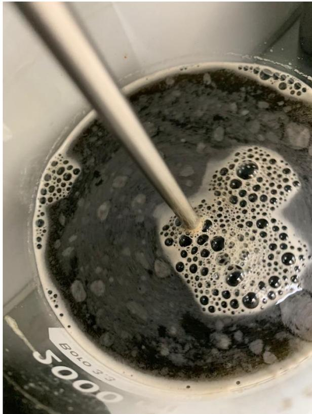
*Anexo 8 Presencia de espuma en la adición de Sulfato de Aluminio en la muestra 5*
