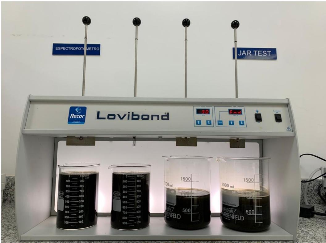
*Anexo 7 Muestras con sedimentación después de la prueba del Jar test*
