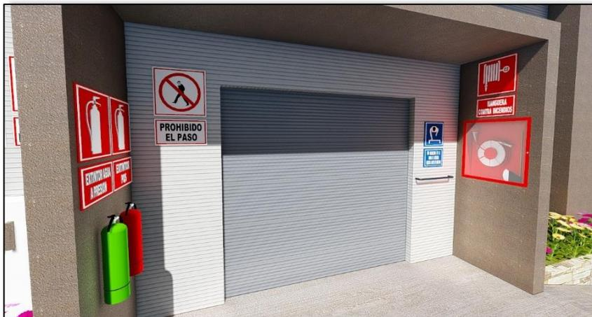
**Figura 93. Vista de la señalización y equipos contra incendios en el acceso del polvorín**
