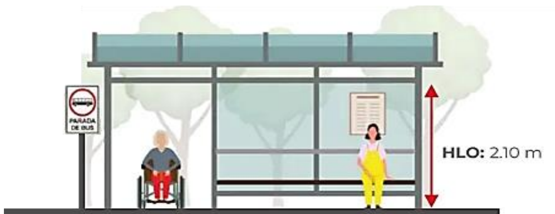
Figura 10: Parada de bus, elevación frontal
