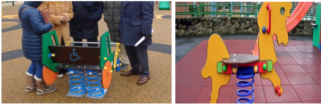
Figura 39: Diferencia de áreas de juegos tipo muelle para niños con y sin discapacidad
