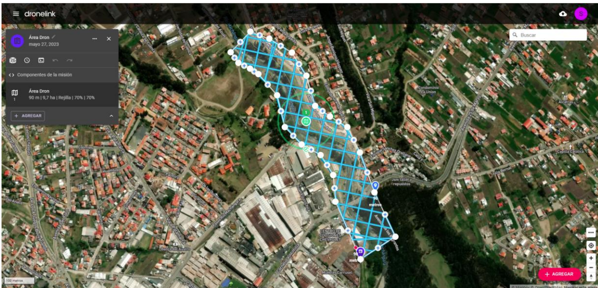
Ilustración 2 Área de planificación del levantamiento
