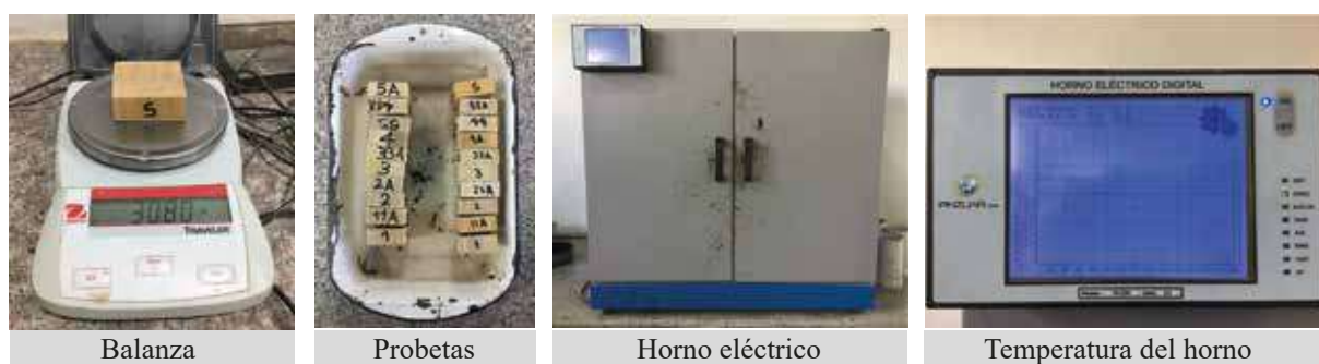
Figura 2.13: Medición de probetas y secado en horno
