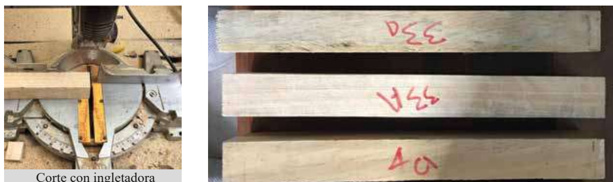
Figura 2.5: Corte con ingletadora y obtención de probetas
