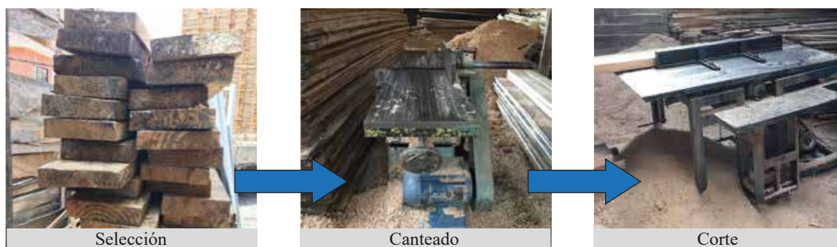
Figura 2.3: Selección, canteado y corte de madera para probetas
