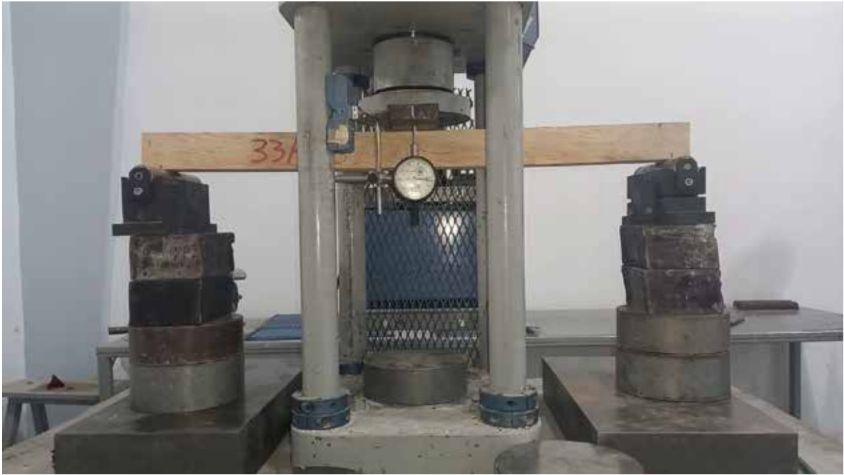
Figura 2.16: Equipo de compresión de hormigón adaptado para ensayos a flexión
