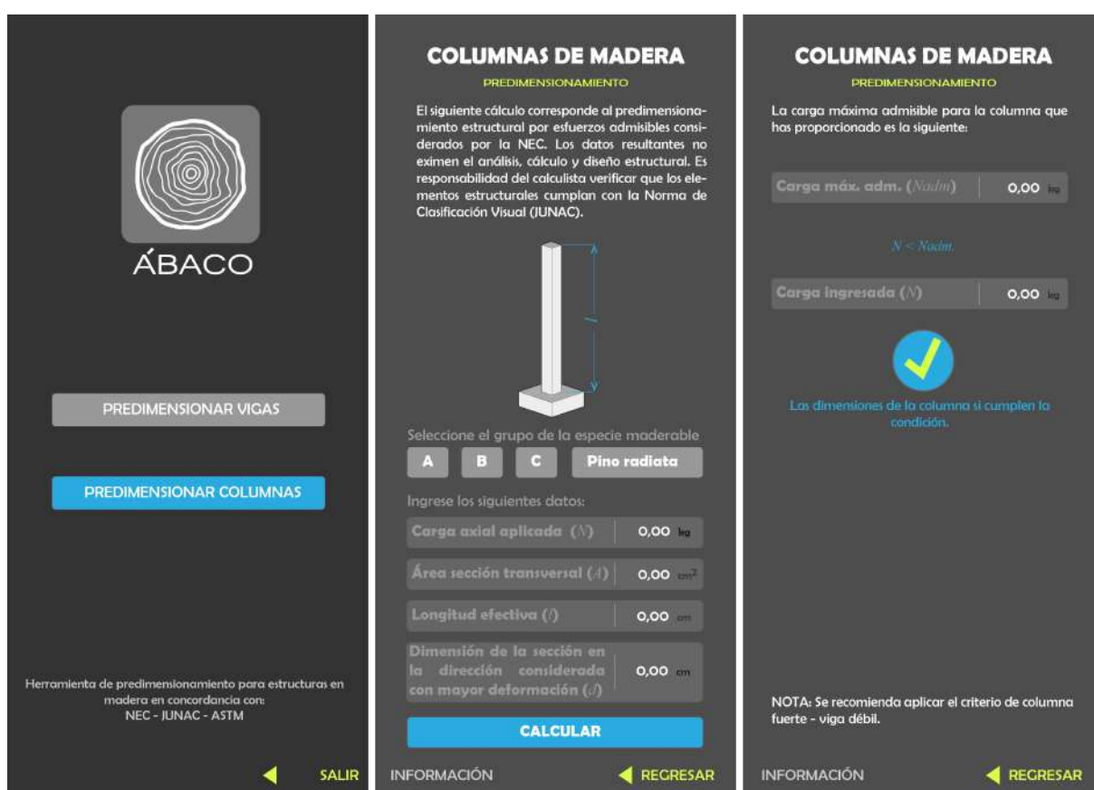
Figura 3.4: Interfaz para el predimensionamiento de columnas
