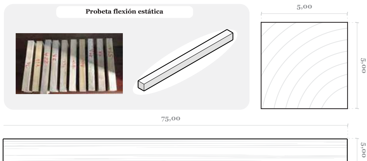
Figura 2.15: Dimensiones de probeta para ensayo de flexión estática
