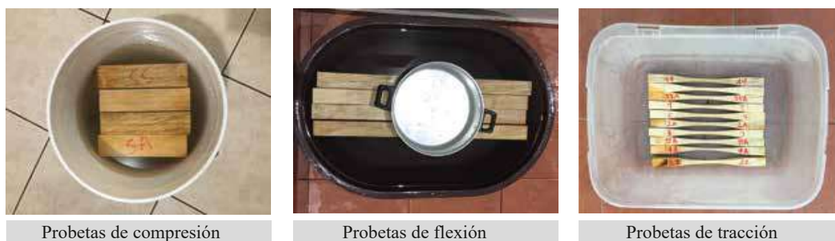
Figura 2.8: Inmersión de probetas en agua
