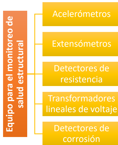
Ilustración 1. Equipo para el monitoreo de salud estructural. Fuente: Autores adaptado de (Marulanda A et al., 2000).
