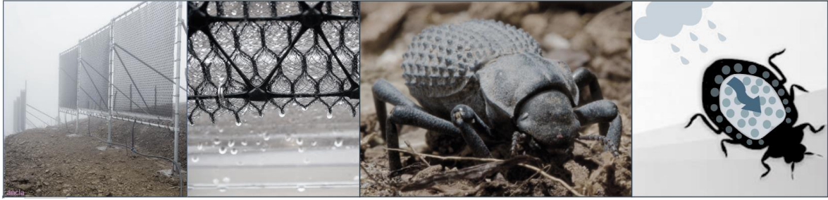
Figura 20: Atrapa nieblas, comparada con la recolección de agua del escarabajo de Namibia.
