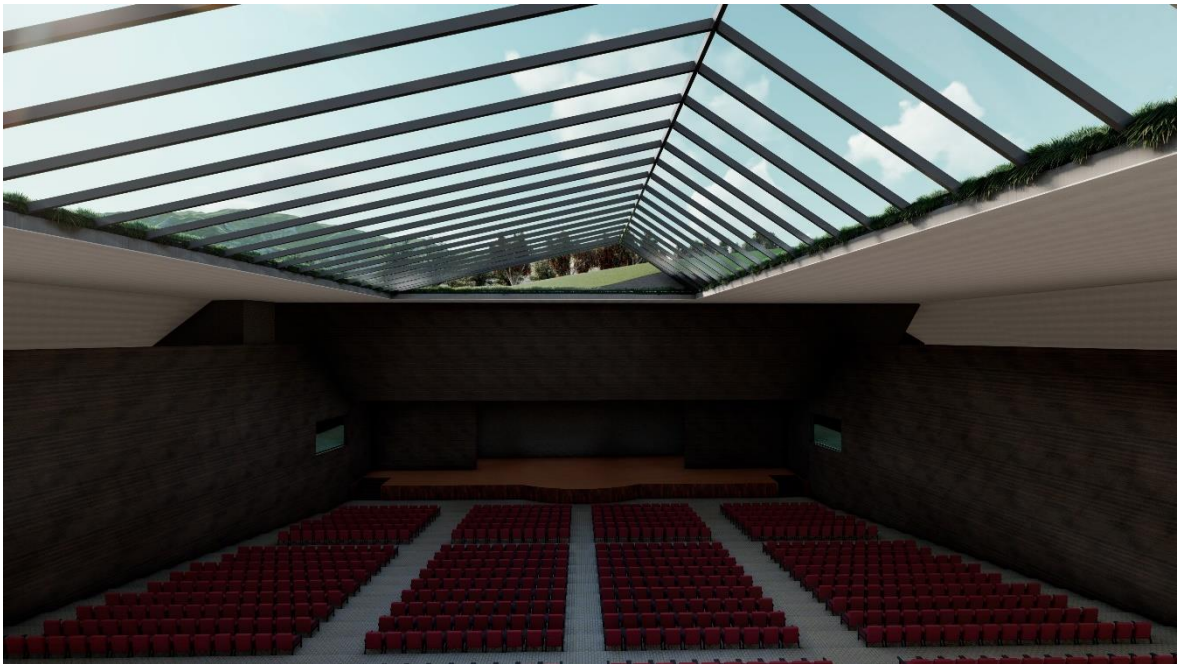
Figura 68: Vista de las ventoleras, sustracciones realizadas para el ingreso de luz natural.
