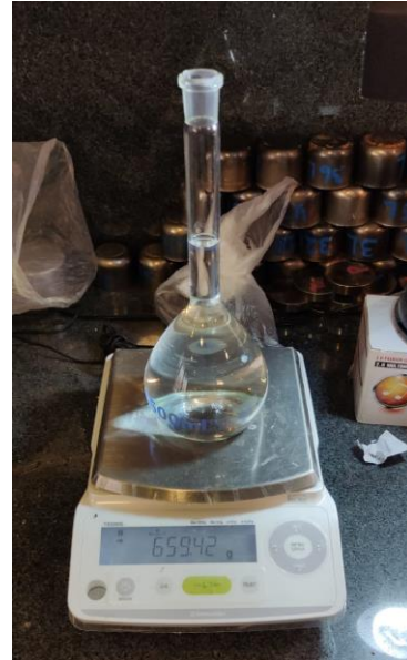
Figura 33 Ensayo de peso específico
