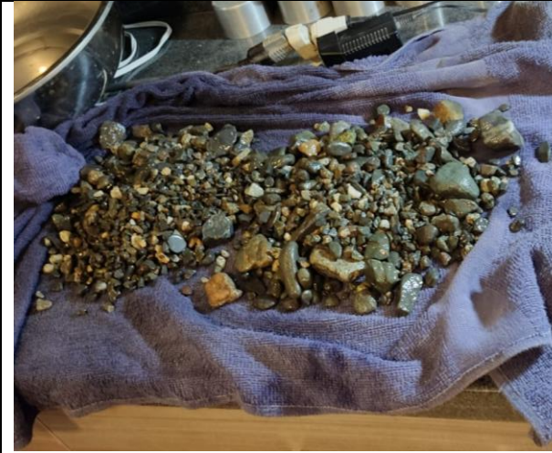
Figura 32 Ensayo de peso específico
