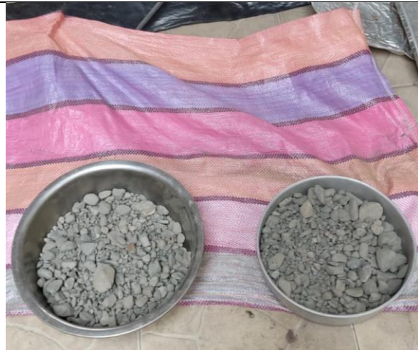
Figura 25 Ensayo de peso volumétrico suelto del agregado grueso.
