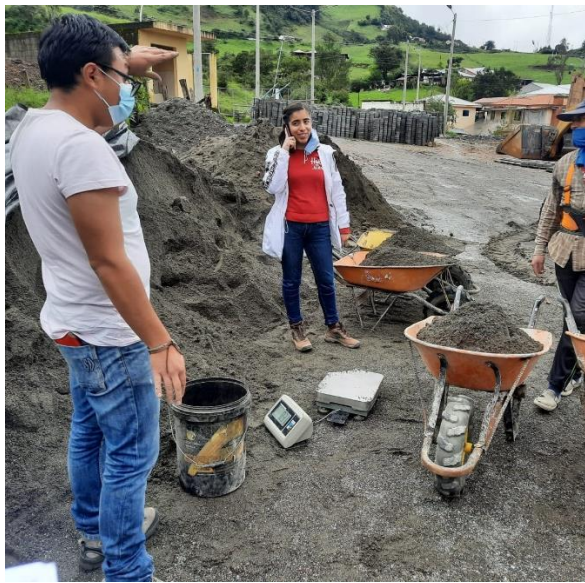
Figura 40 Pesaje del agregado fino.
