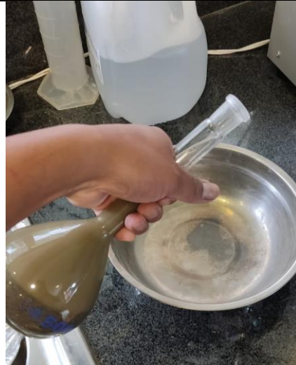
Figura 29 Ensayo de peso específico.
