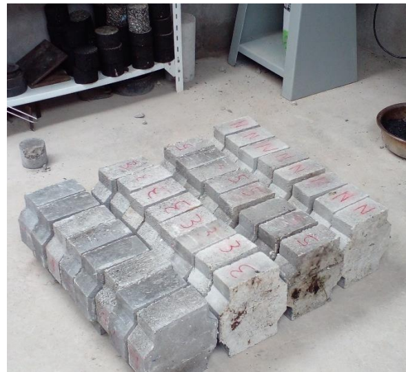
Figura 55 Núcleos de adoquines a romper a compresión
