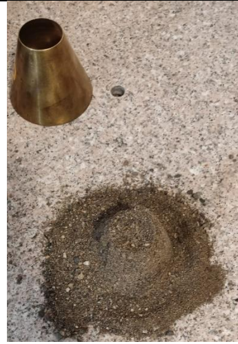
Figura 33 Ensayo de peso específico
