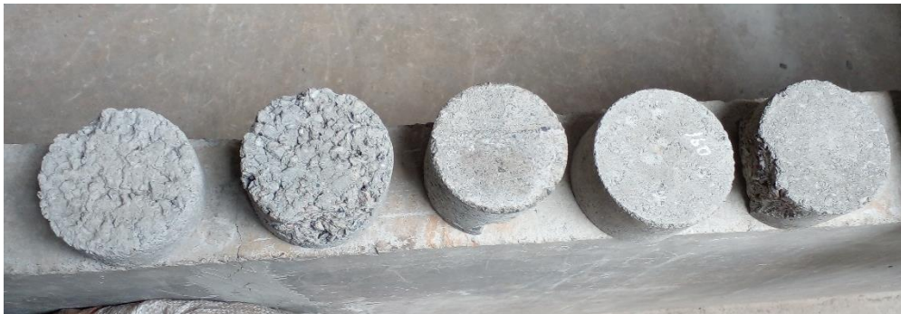
Figura 12 Mezcla inicial de adoquines preliminar, superficie rugosa.
