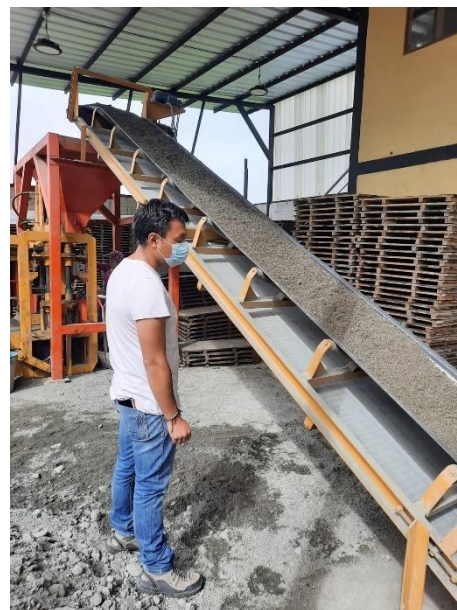
Figura 45 Banda transportadora de mezcla.
