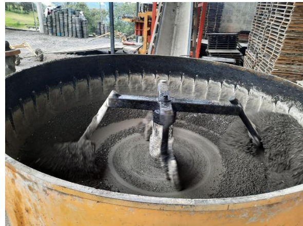
Figura 41 Mezcla para adoquines
