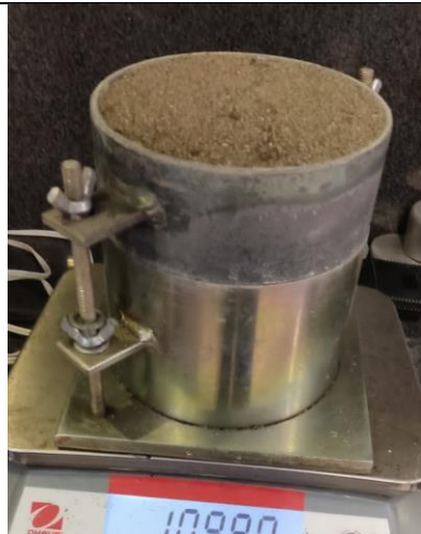
Figura 24 Ensayo de peso volumétrico compactado.
