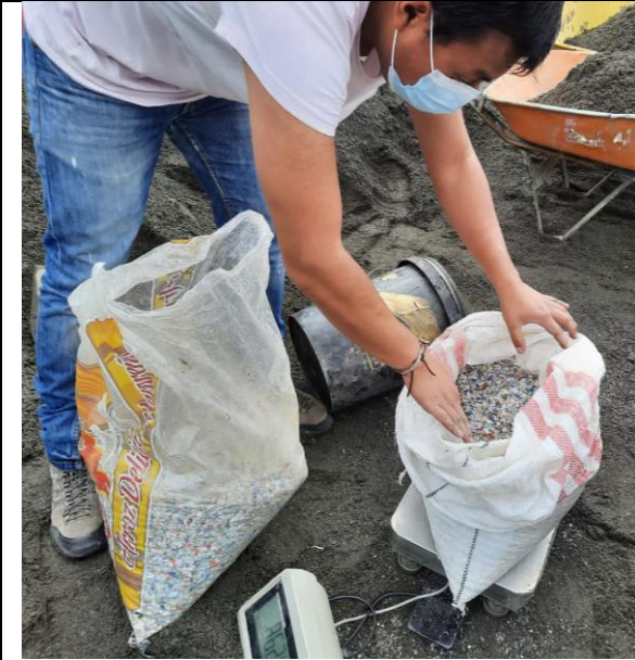
Figura 40 Pesaje del agregado fino.
