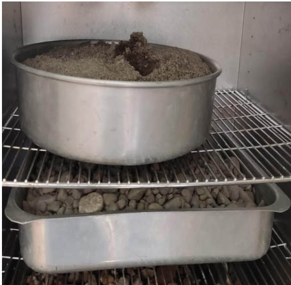
Figura 20 Secado de los agregados al horno.
