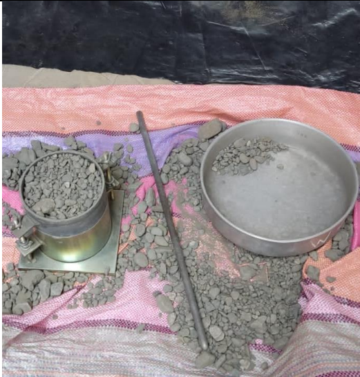
Figura 28 Ensayo de peso específico del agregado grueso.
