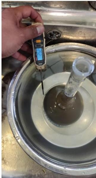
Figura 32 Ensayo de peso específico
