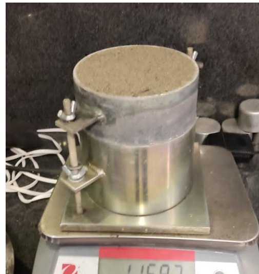
Figura 21 Ensayo de peso volumétrico suelto.
