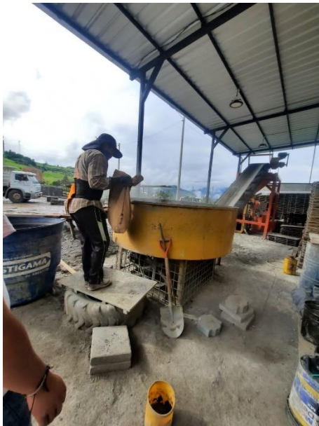
Figura 48 Implementación del cementante en la mezcla.
