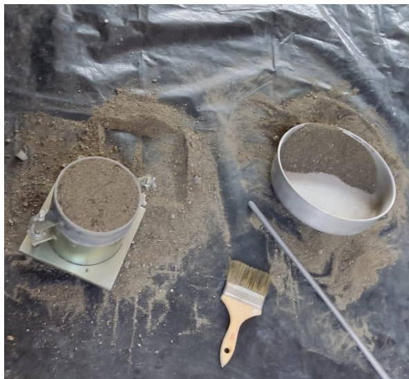
Figura 24 Ensayo de peso volumétrico compactado.
