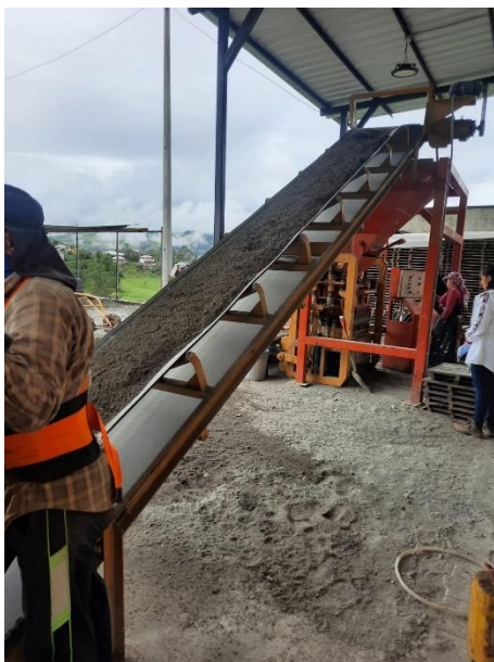
Figura 44 Banda transportadora de mezcla.
