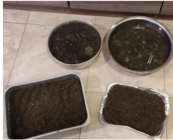
Figura 21 Ensayo de peso volumétrico suelto.
