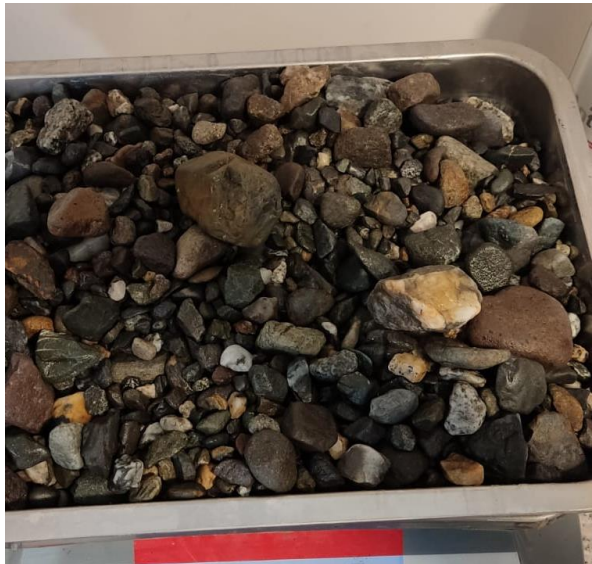
Figura 28 Ensayo de peso específico del agregado grueso.
