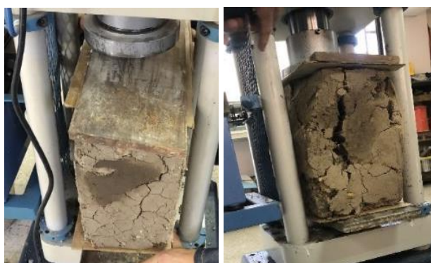
Figura 10. Ensayos al Bahareque.
