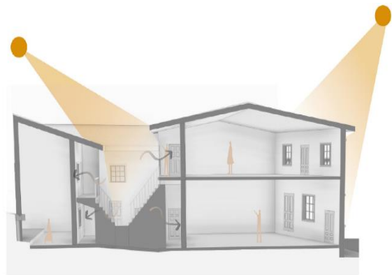
Figura 57: Ventilación, Lote D Elaboración: Grupo de tesis
