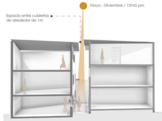
Figura 53: Ventilación, lote C Elaboración: Grupo de tesis
