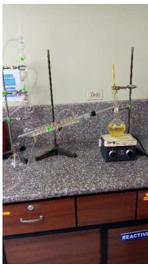
Figura 5: Equipo de destilación.
