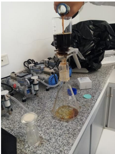
Ilustración 10: filtración al vacío del extracto.
