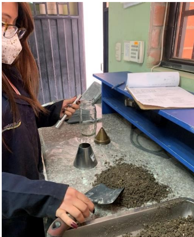
Figura 4-8 Proceso en el cálculo del estado Saturado y Superficial Seco de la arena. Fuente: El Autor.
