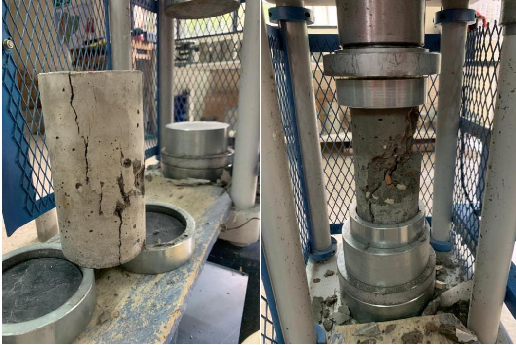
Figura 4-16 Ensayos de la misma relación A/C, pero con porcentajes de escombros diferentes. Fuente: El Autor.
