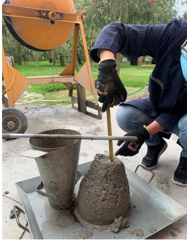
Figura 4-13 Evaluación del asentamiento a través del cono de Abrams. Fuente: El Autor.
