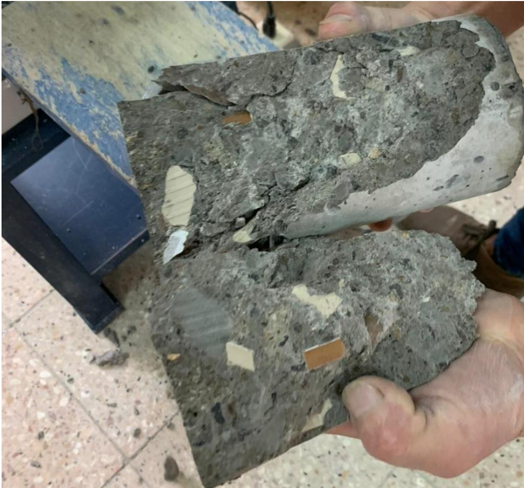
Figura 5-8 Falla Tipo 4. Fuente: El Autor.
