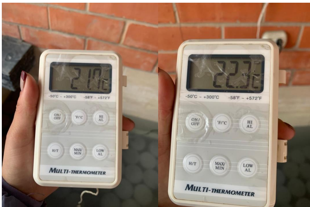
Figura 4-14 Control de temperatura y curado por inmersión. Fuente: El Autor.
