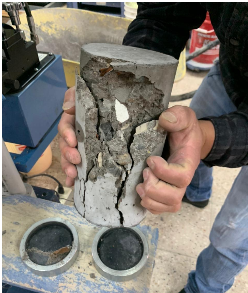
Figura 5-9 Falla Tipo 3. Fuente: El Autor.
