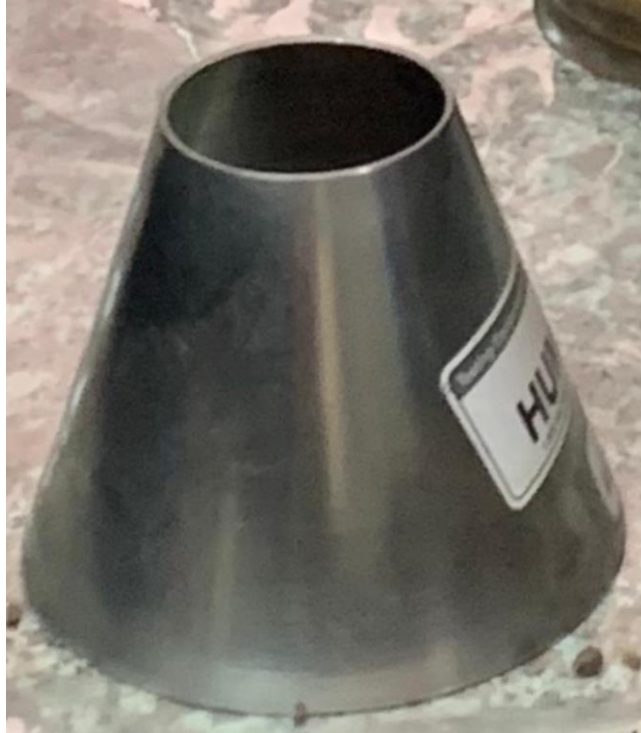
Figura 2-1 Cono empleado en el cálculo del estado SSS en la arena. Fuente: El Autor
