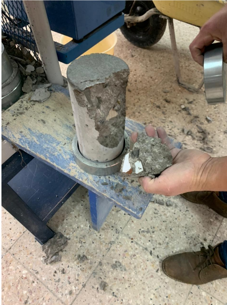
Figura 5-10 Falla Tipo 5. Fuente: El Autor.
