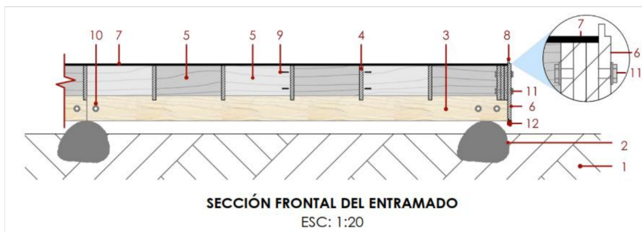
FIGURA 5.12: Configuración constructiva del entramado para forjado.
