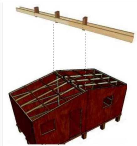
FIGURA 1.39: Viga maestra de la vivienda que usa la fundación Techo en los Andes del Ecuador. Tomada de Sandoval, 2013
