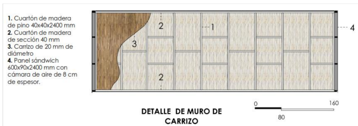
FIGURA 5.22: Detalle de muro de carrizo.
