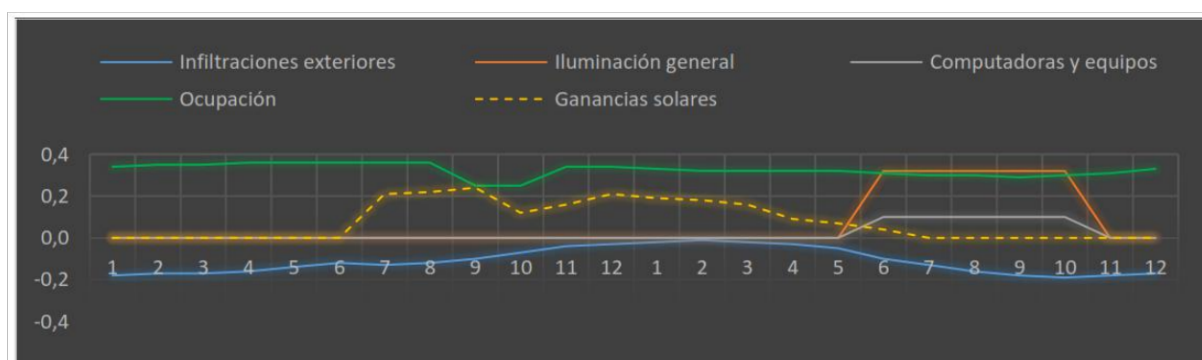
FIGURA 5.55: Flujos de calor de la zona 1 en un día. Figura realizada con datos extraídos de DesignBuilder.
