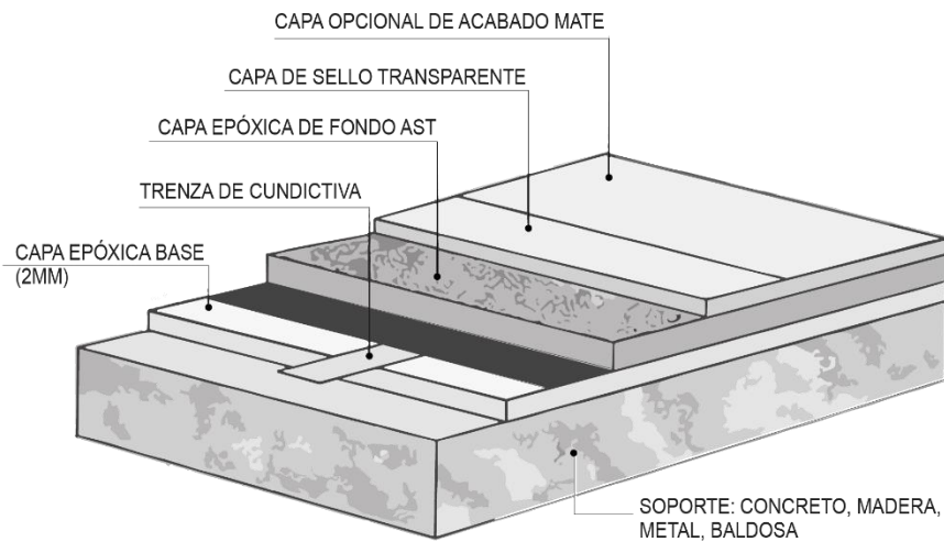
Figura 80: Esquema de suelo epóxico
