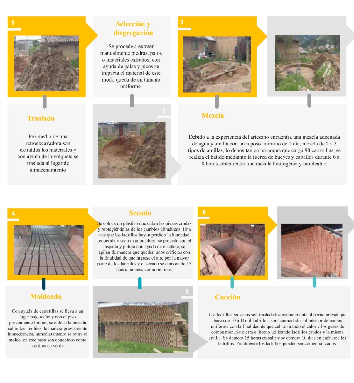
Figura 1.40: Proceso de elaboración del ladrillo Panelón
