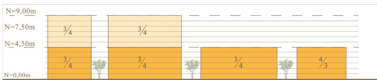
Figura 3.10: Explicación de la modulación propuesta en elevación
