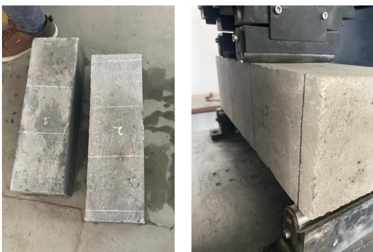
Ilustración 37: Marcación y ensayo de las vigas
