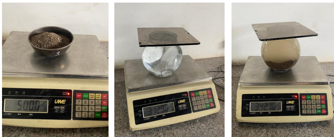
Ilustración 14: Ensayo del picnómetro para agregado fino.
