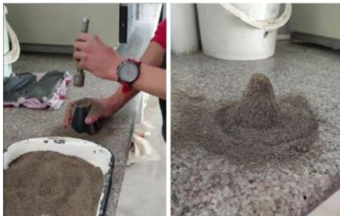
Ilustración 13: Ensayo de cono truncado.
