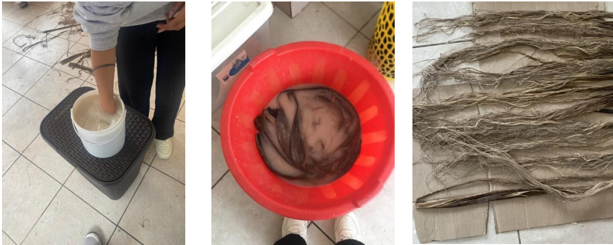
Ilustración 20: Tratamiento de las fibras de vástago de plátano con hidróxido de cal.
