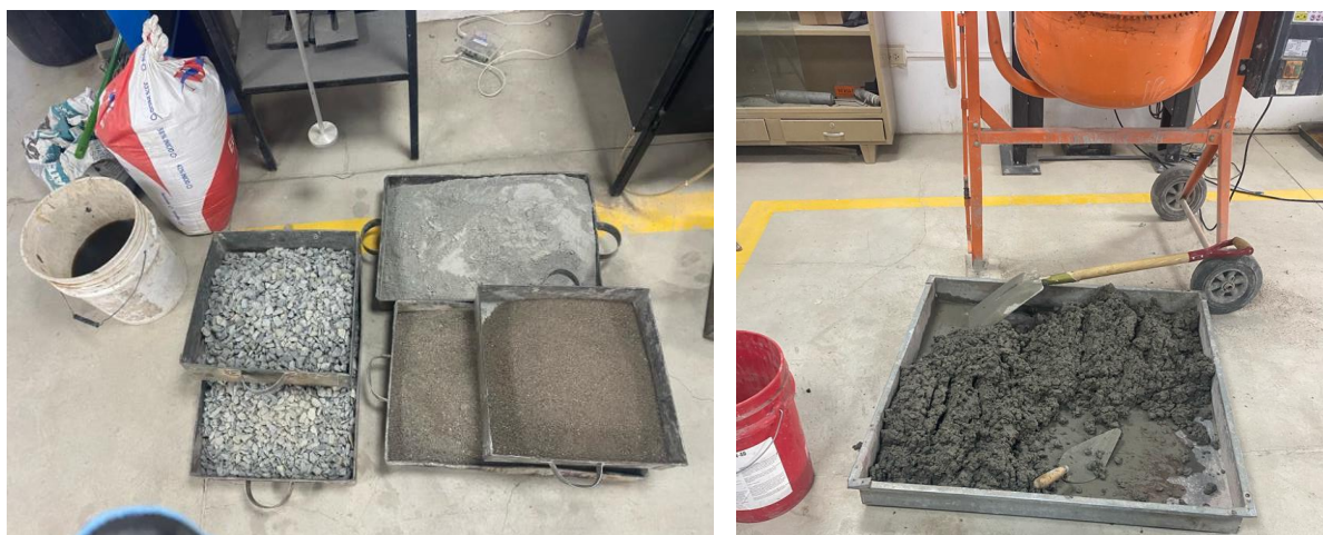
Ilustración 21: Pesaje de material para elaboración del hormigón sin fibras.
