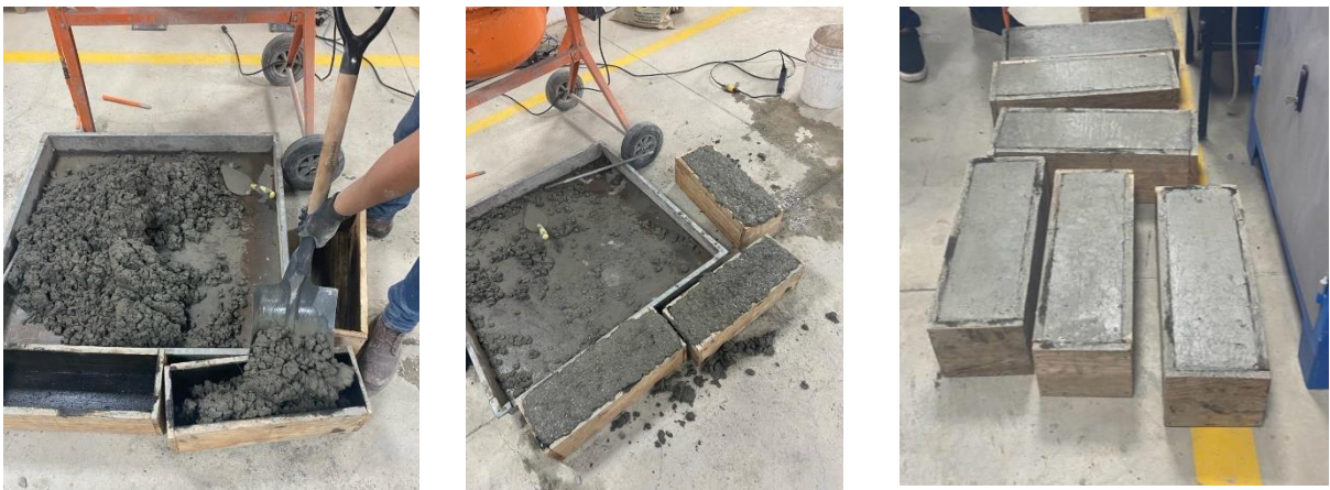
Ilustración 26: Elaboración de vigas de hormigón con adición de fibras de vástago de plátano.
