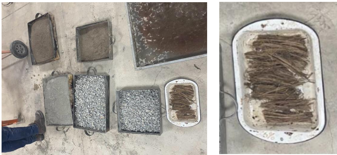
Ilustración 24: Cantidades de materiales y fibra a incorporar en la mezcla de hormigón.
