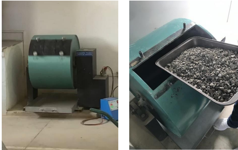
Ilustración 15: Ensayo de abrasión en la máquina de los ángeles.
