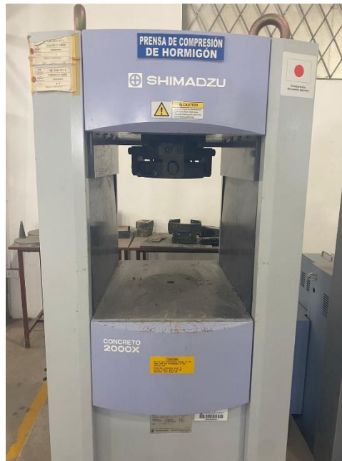
Ilustración 3: Máquina de ensayo a compresión en especímenes cilíndricos de hormigón.
