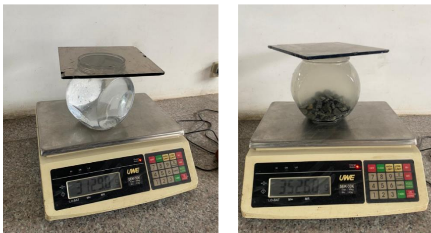
Ilustración 11: Proceso del picnómetro para la obtención de la masa en estado S.S.S.
