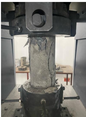
Ilustración 29: Cilindro con el 0.3% de fibras.
