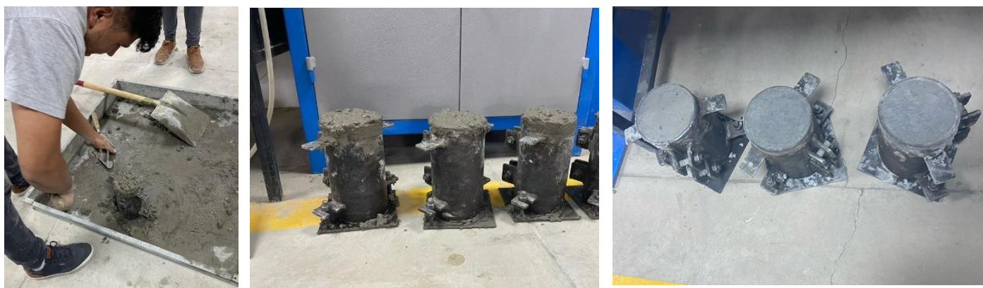
Ilustración 27: Elaboración de cilindro de hormigón con adición de fibras de vástago de plátano.
