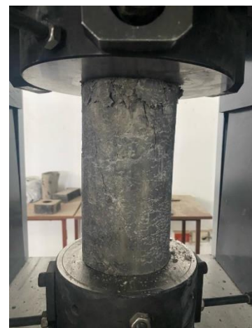
Ilustración 30: Cilindro con el 0.5% de fibras.
