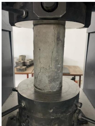
Ilustración 31: Cilindro con el 0.1% de fibras.
