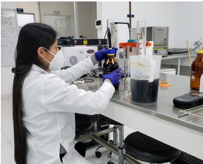
Figura 15: Colocación del lixiviado en el reactor construido para iniciar la experimentación
