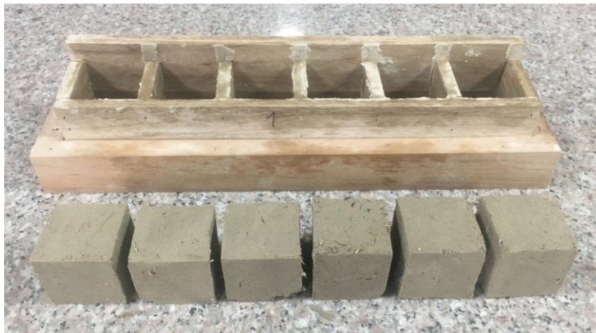
Figura 107: Desmolde de los cubos.
