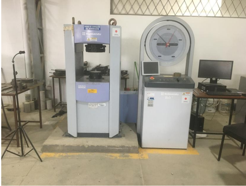
Figura 110: Prensa de compresión.
