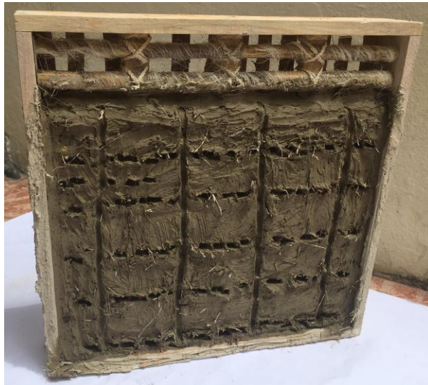
Figura 18: Rayado de la superficie húmeda del muro.
