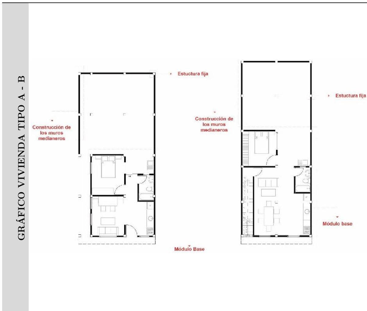
Construcción muros medianeros y módulo base de la vivienda tipo A-B: - Elaboración: Christian Díaz.
