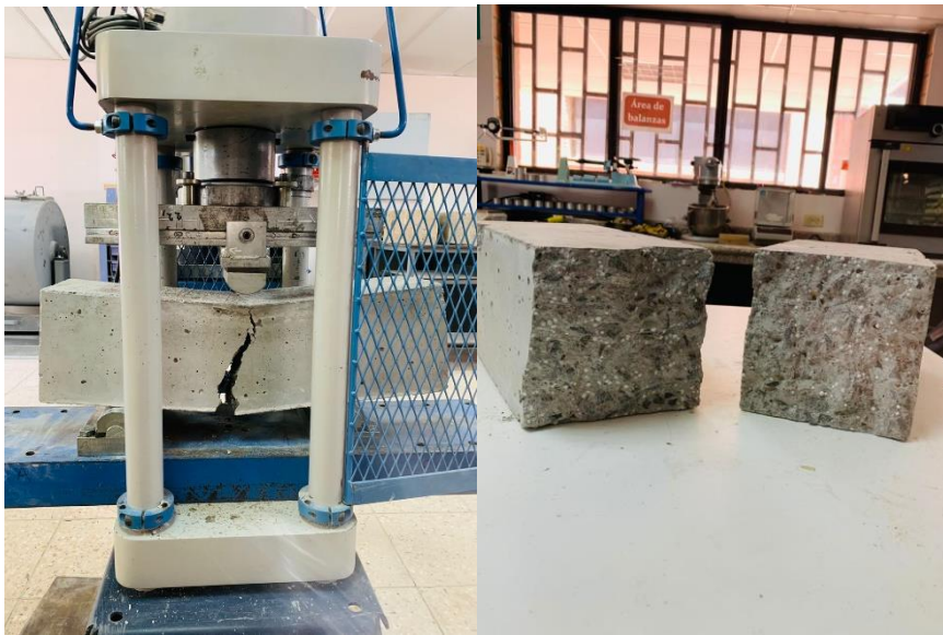
Figura 5: Rotura de vigas
