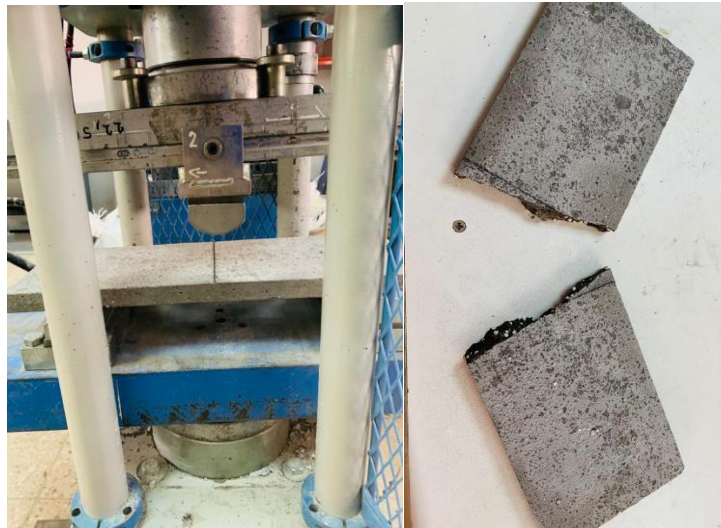
Figura 8: Rotura del material ensayado (hormigón con 50% de poliestireno)
