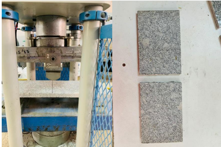
Figura 7: Rotura del material comparativo (granito)
