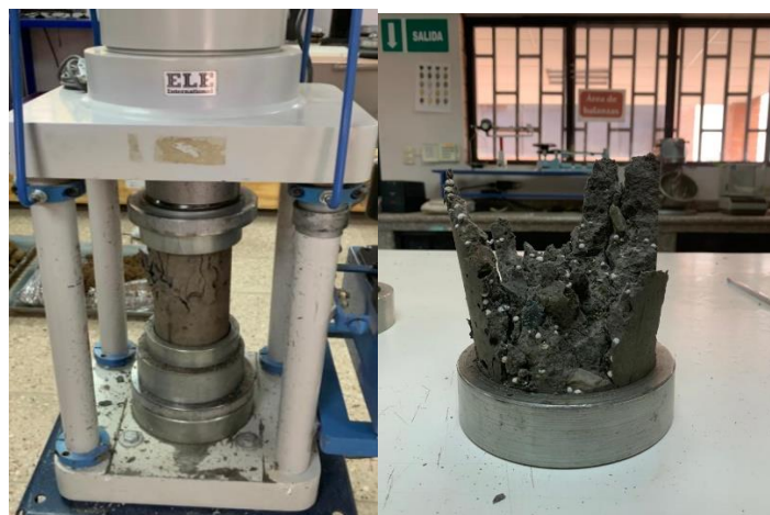
Figura 3: Ensayo a compresión de muestras cilíndricas
