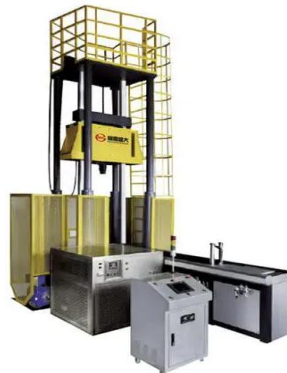
Figura 13. Máquina para ensayo de impacto por caída libre DWTT series.
