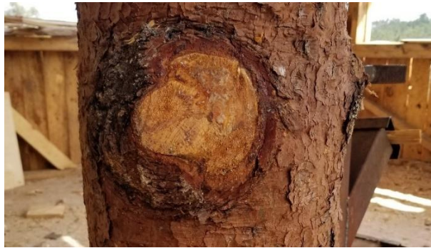
Fig. 15. Nudo Sano en Madera Aserrada
