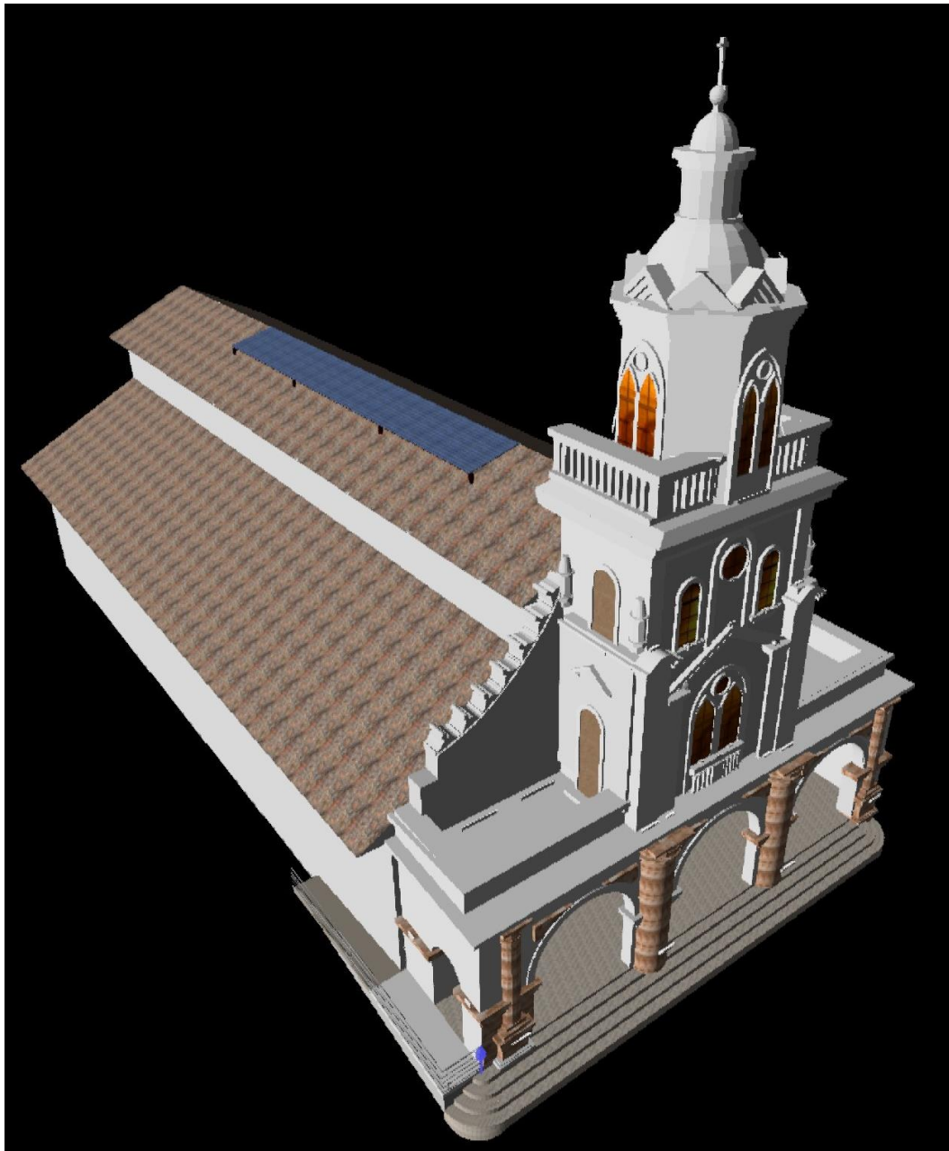
Fig. 27 Ubicación de los paneles fotovoltaicos
