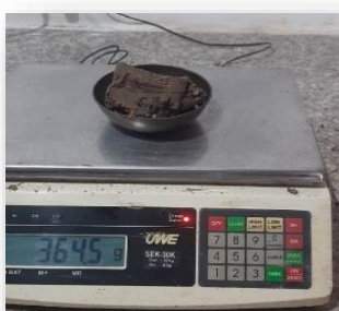
Imagen 51: Peso húmedo + Contenedor P2
