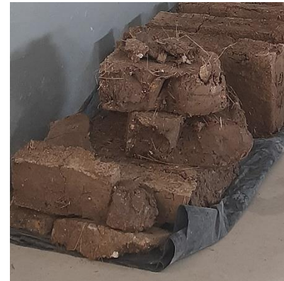
Imagen 58: Escombros resultado de la rotura de probetas 1 y 2
