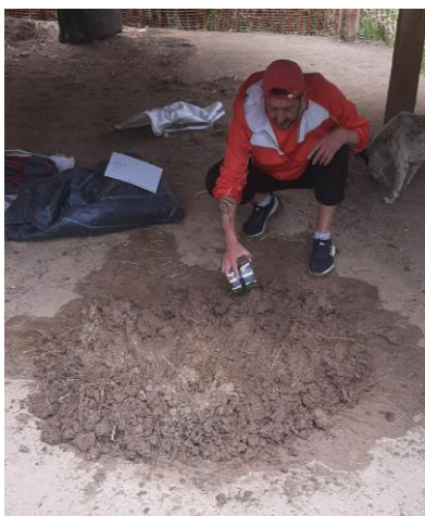
Imagen 33: Adición de lodos aluminosos.
