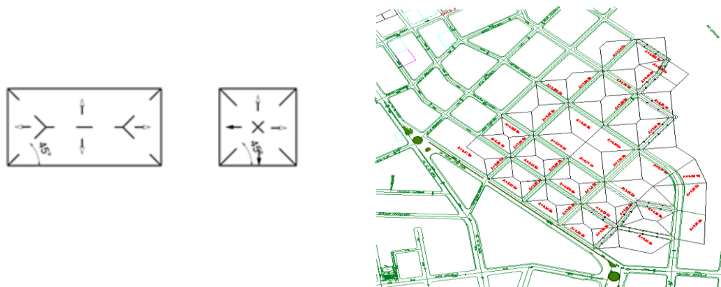
Fig. 26 Esquema de división de áreas tributarias para cada colector del proyecto
