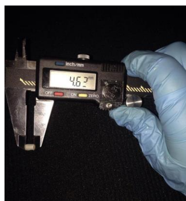
10. Medición de la altura de las muestras de resina con el micrómetro digital
