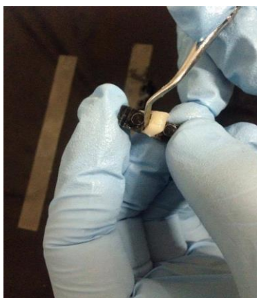
7. Retiro de la muestra de resina del cilindro con una espátula
