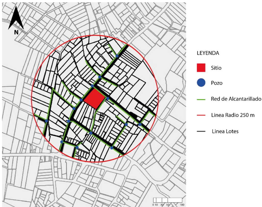
Figura 3.40: Mapa red alcantarillado sanitario.
