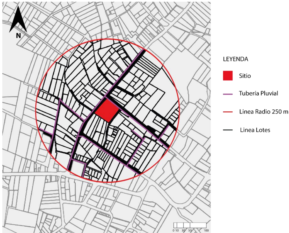
Figura 3.41: Mapa red alcantarillado pluvial.
