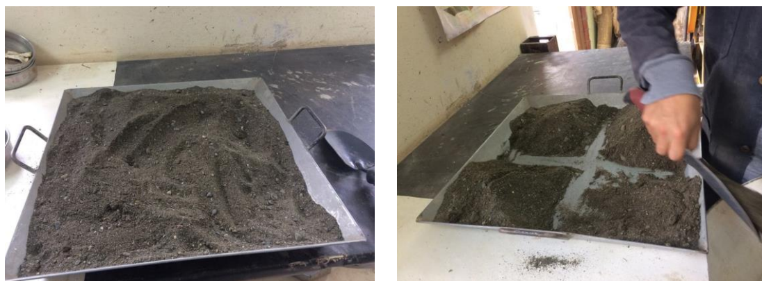
Ilustración N° 11 Cuarteo del agregado fino
