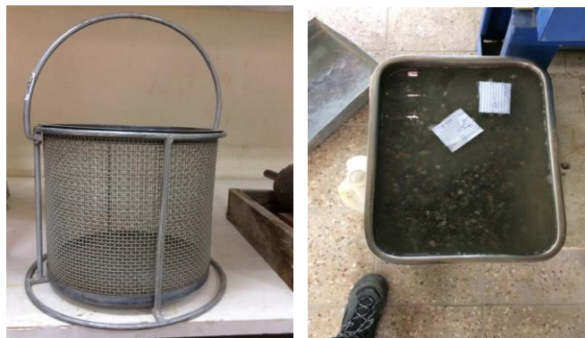
Ilustración N° 14 Canastilla y saturación del agregado para el ensayo de absorción
