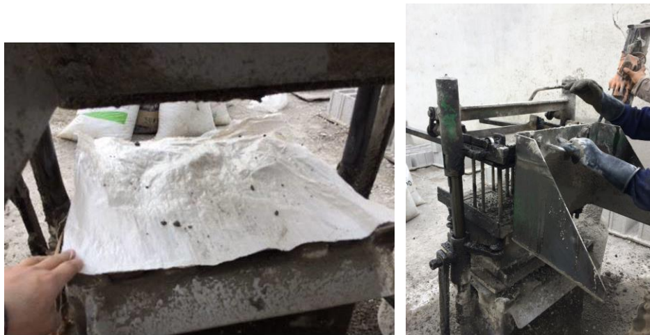
Ilustración N° 7 Proceso para el prensado de los bloques
