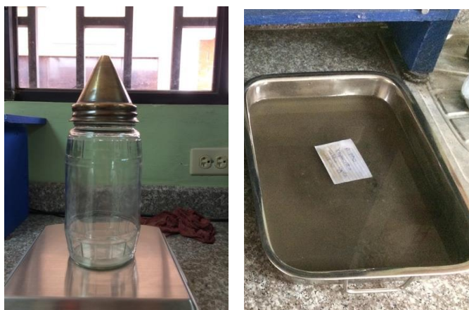
Ilustración N° 13 Picnómetro y saturación del agregado
