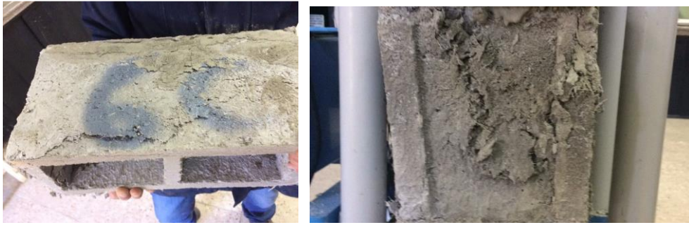
Ilustración N° 21 Falla de bloques de hormigón con el 6% de fibra
