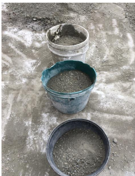
Ilustración N° 5 Parihuelas para la cuantificación de las cantidades de los agregados
