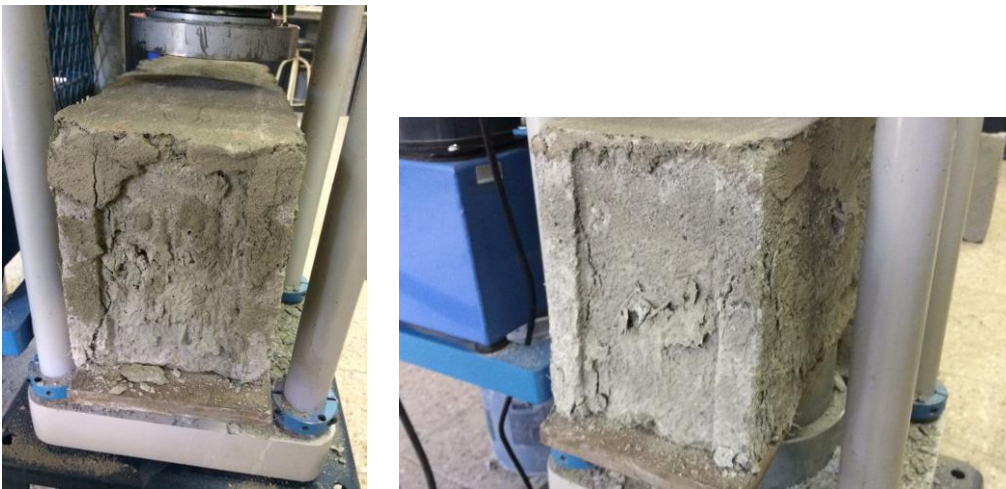
Ilustración N° 22 Falla de bloques de hormigón con el 9% de fibra
