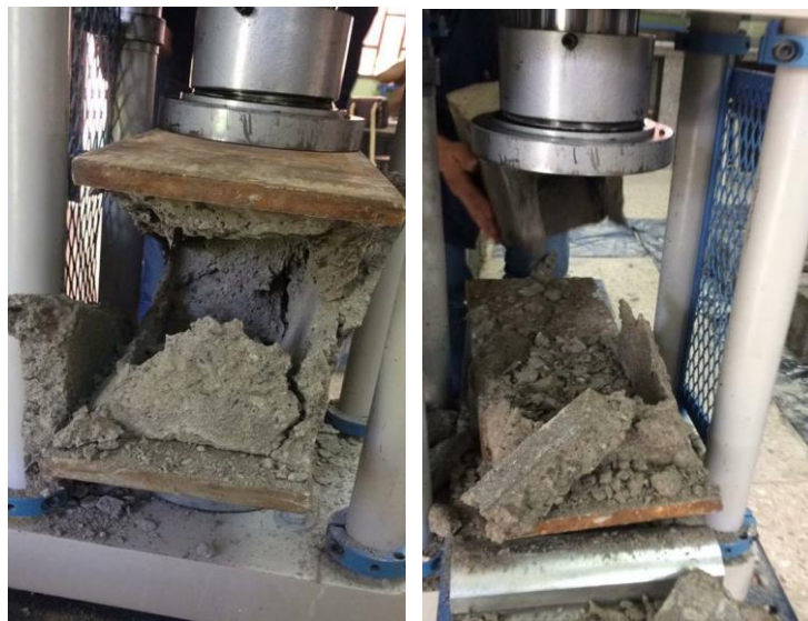
Ilustración N° 19 Falla de los bloques de hormigón tradicional
