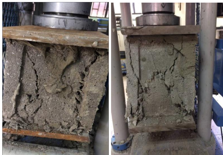
Ilustración N° 20 Falla de los bloques de hormigón con el 3% de fibra
