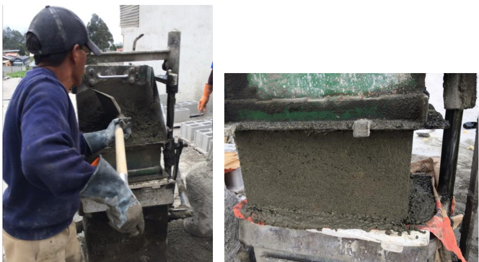
Ilustración N° 8 Moldeado de los bloques
