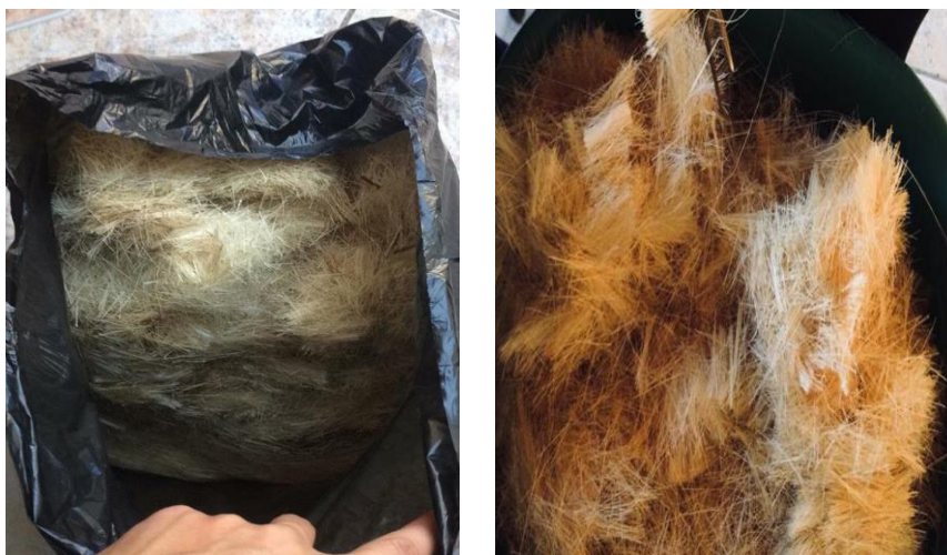
Ilustración N° 2 Fibra de cabuya de 2,5 cm de longitud
