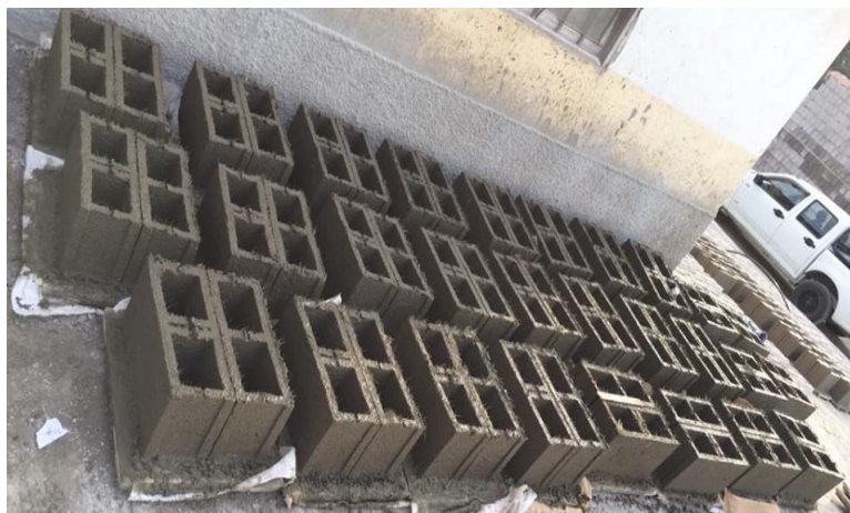
Ilustración N° 9 Acomodo de los bloques elaborados
