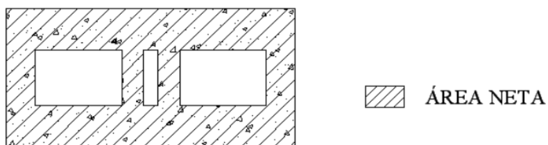
Figura N° 6 Área neta del bloque de Hormigón
