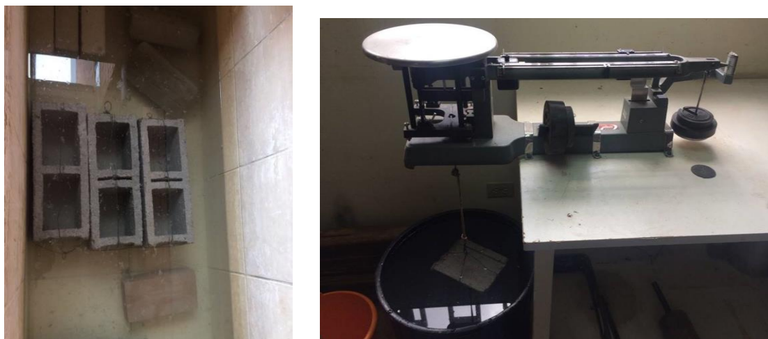
Ilustración N° 16 Ensayo de absorción de los bloques
