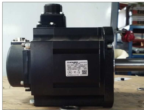
Figura 35. Servomotor de 1KW serie HF-SP-102 Fuente: Cortesía de Induglob
