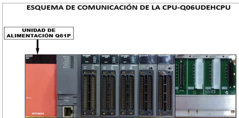
Figura 46. Esquema del Módulo de Alimentación Q61P a los dispositivos de hardware Fuente: Autor
