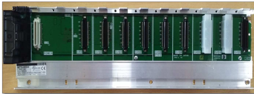
Figura 45. Unidad Base Q38DB para el montaje de los módulos inteligentes. Fuente: Cortesía de Induglob
