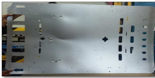
Figura 26. Plancha Frontal 32" QZ troquelada. Fuente: Cortesía de Induglob
