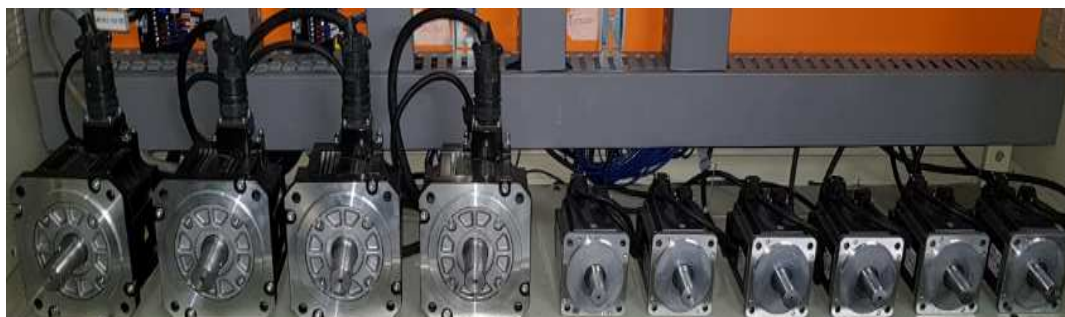
Figura 72. Conexión de prueba de los servomotores.
