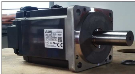
Figura 29. Servomotor de 750 W. Serie HF-KP-73
