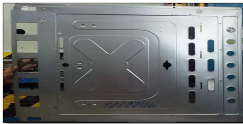
Figura 27. Plancha Frontal 32" QZ estampada. Fuente: Cortesía de Induglob
