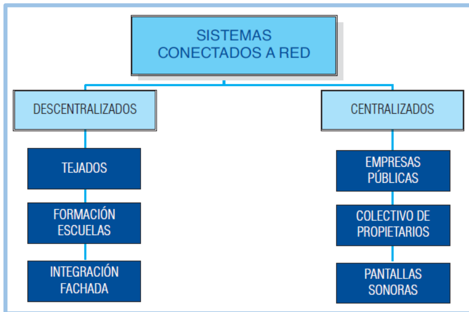
Figura 2.11: Aplicaciones de la energía fotovoltaica
