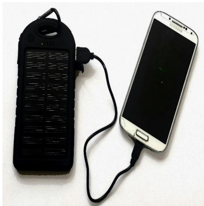
Fig.8 Sistema Fotovoltaico Directo.
