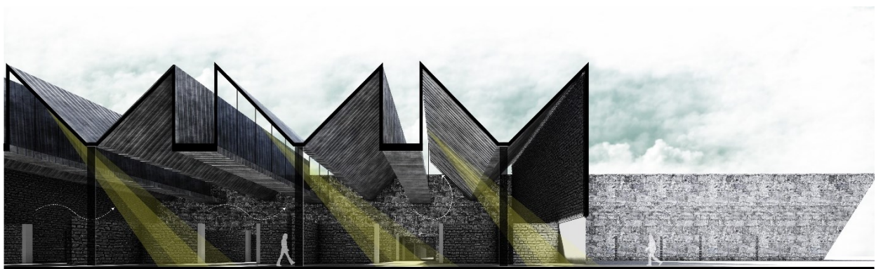
Figura 54: Iluminación y ventilación de los espacios internos del mercado Acuña
