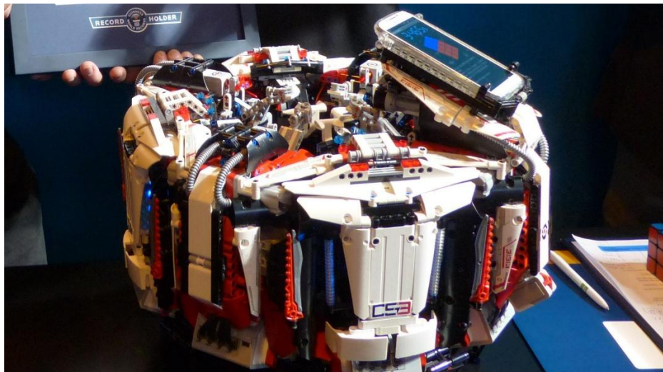
Figura 3: CubeStormer III, un robot construido con LEGO Mindstorms
