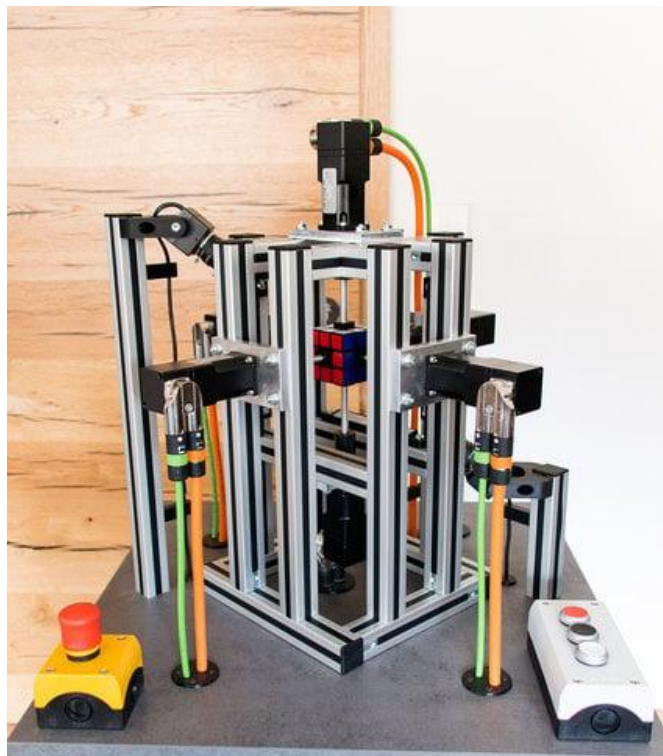
Figura 5: SIGMATEK, sistema para resolver cubos Rubik que crearon estudiantes de la HTL Saalfelden en una comunidad de Austria
