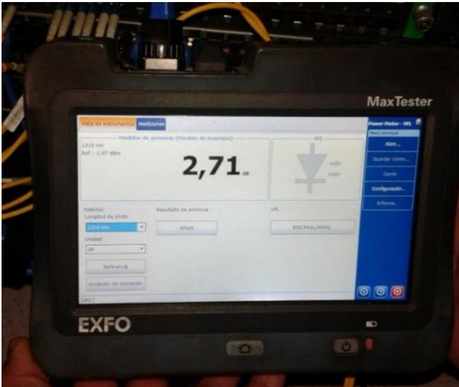
Fig. 29 Medida de potencia a la salida del Puerto OLT Fuente: (Puntonet)
