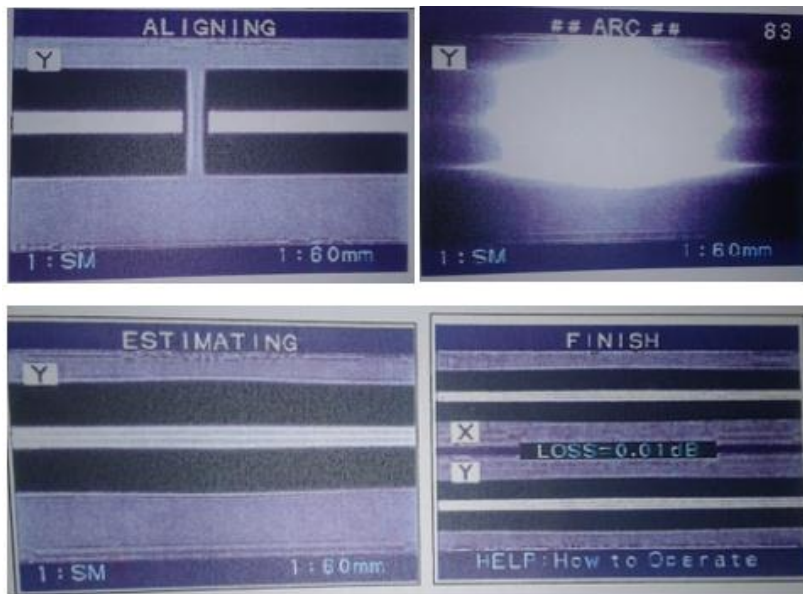
Fig. 74 Fusión de los hilos de fibra con pérdida de 0.01 dBm Fuente: (QFC, 2010)
