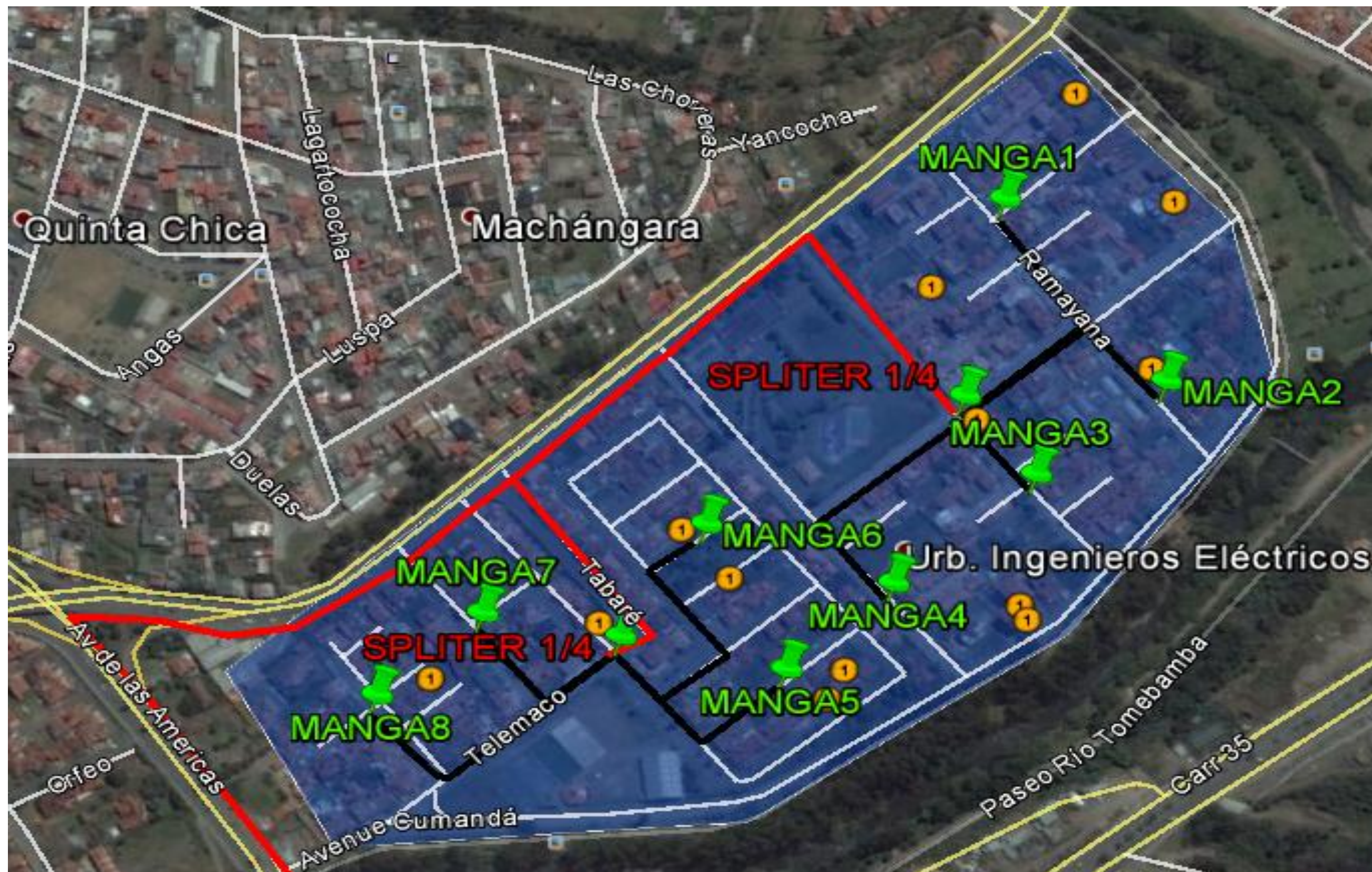
Anexo A Red FTTH Ciudadela de los ingenieros empresa Puntonet Fuente: (Investigador)
