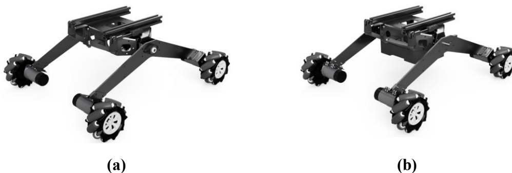
Figura 18 Ensamble del diseño mecánico: (a) Ensamble piezas de aluminio de 2mm; (b) Ensamble piezas de aluminio y tapa inferior del chasis; (c) Pasos de ensamble.
