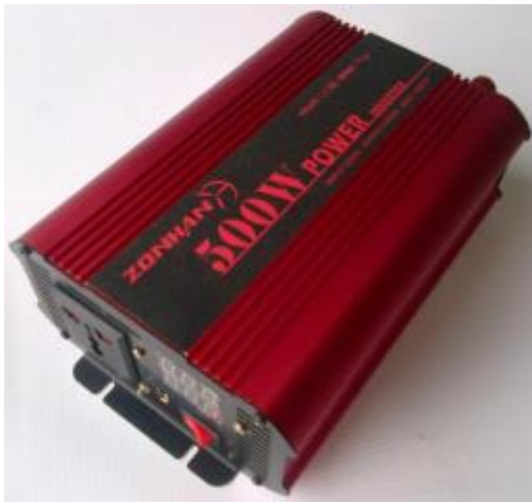
Ilustración 20. Inversor ZONHAN Microinverter (500W).
